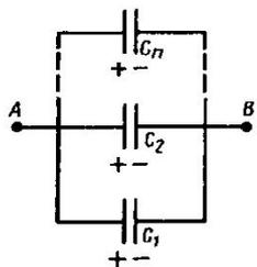
конденсаторов одинакова и равна  $\phi_A - \phi_B$ . Если емкости отдельных конденсаторов  $C_1, C_2, \dots, C_n$ , то, согласно (3), их заряды равны
