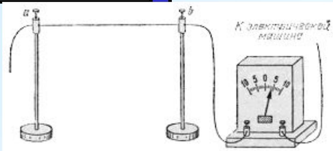
Натянем на двух высоких изолирующих подставках металлическую проволоку  $ab$  и соединим ее с отрицательным полюсом генератора. Второй полюс генератора отведем к Земле. Получится своеобразный конденсатор, обкладками которого являются проволока и стены комнаты, которые сообщаются с Землей.
