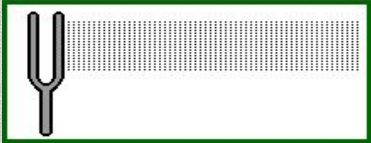
**Камертон** - представляет собой металлическую "рогатку", укрепленную на ящичке, у которого нет одной стенки. Если специальным резиновым молоточком ударить по "ножкам" камертона, то он будет издавать звук, называемый музыкальным тоном.
