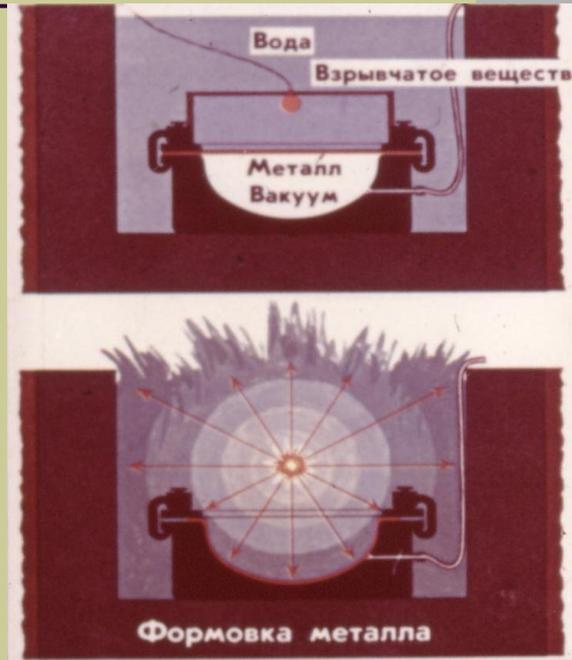
Сверхвысокое давление ( $30\,000\,000\,000\text{ Па}$ ) на больших площадях возникает при взрыве. Взрыв формует металлы, прокладывает траншеи. А в этом агрегате взрыв сваривает медь и алюминий, медь и сталь.
