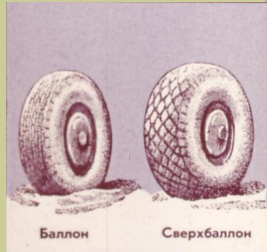
Чтобы уменьшить давление на грунт, тяжелые машины ставят на широкие колёса. Для передвижения в пустынях машины снабжают сверхбаллонами.
