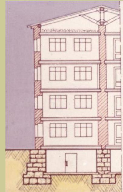
Проектируя здания, учитывают их давление на грунт. Для уменьшения давления постройки на фундамент увеличивают площадь его нижней части.
