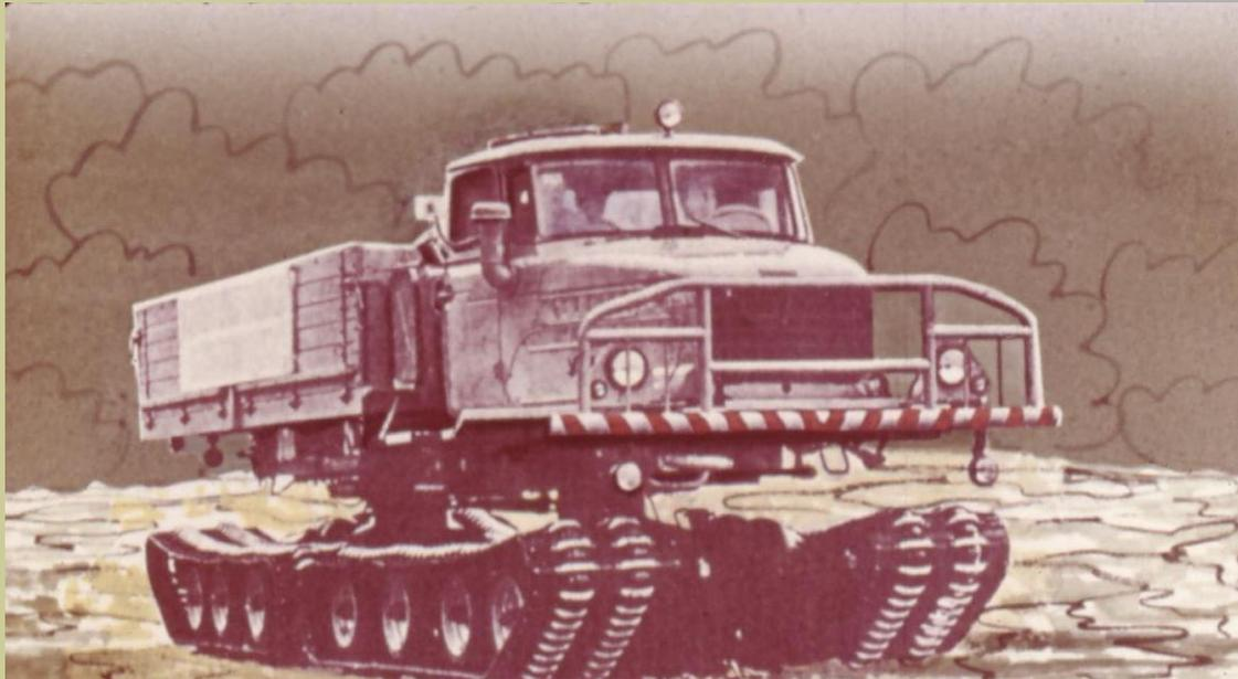
В условиях бездорожья, заболоченных участков, снежной целины хорошо зарекомендовали себя вездеходы, обладающие высокой проходимостью. Давление снегоболотохода на грунт при нагрузке 80 000Н в 10-20 раз меньше , чем давление грузовика.
