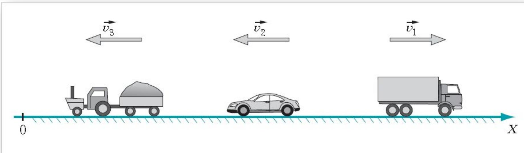
Масса грузового автомобиля равна  $m_1 = 10$  т, легкового автомобиля  $m_2 = 1$  т, трактора с прицепом  $m_3 = 4$  т. Найдём импульсы каждого из движущихся тел, если модули их скоростей одинаковы и равны  $u = 10$  м/с.
