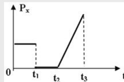
**№13:** На рисунке показана зависимость проекции импульса тела от времени. Определить величину проекцию силы под действием которой данное тело двигалось до остановки.
