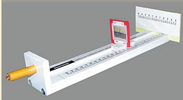
Определение длины световой волны с помощью дифракционной решетки
