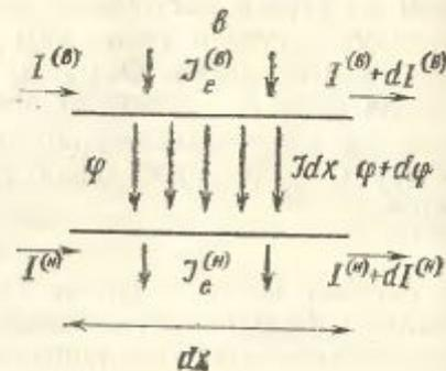
Рис. 11.1. Цепочка параллельно соединенных контактов (а), эквивалентная схема одной ее ячейки (б) и токи в малом отрезке структуры (в)
