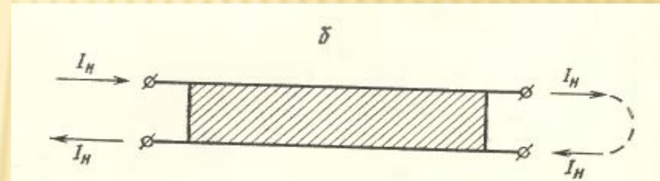
Рис. 11.2. Токи на краях распределенного перехода: общий случай (а) и пример задания токов, эквивалентных внешнему магнитному полю (б)  $I_H = tB_e / \mathcal{L}_0$
