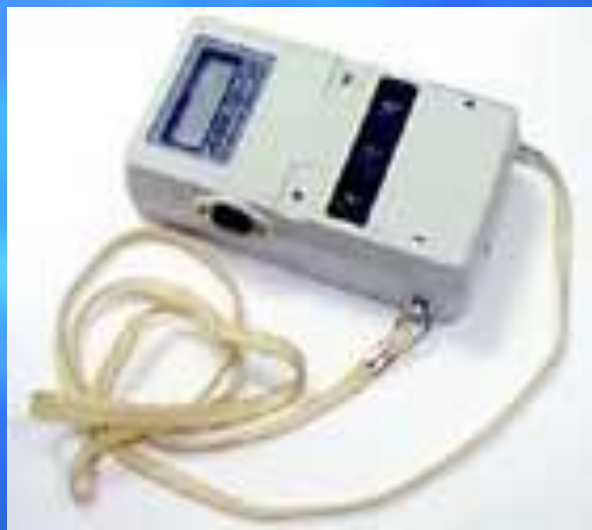
дозиметр-радиометр гамма- и бета-излучения АНРИ-01-02 "Сосна".
