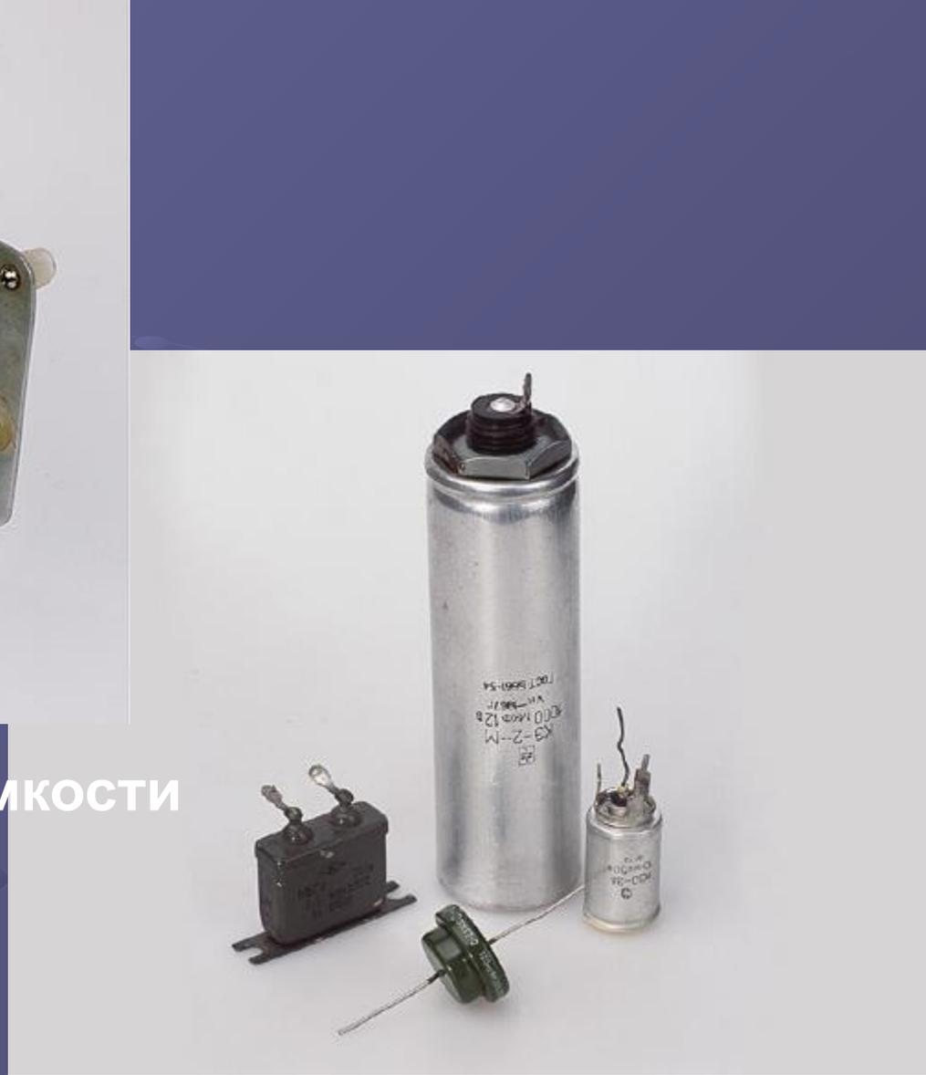
**Конденсатор постоянной емкости**
