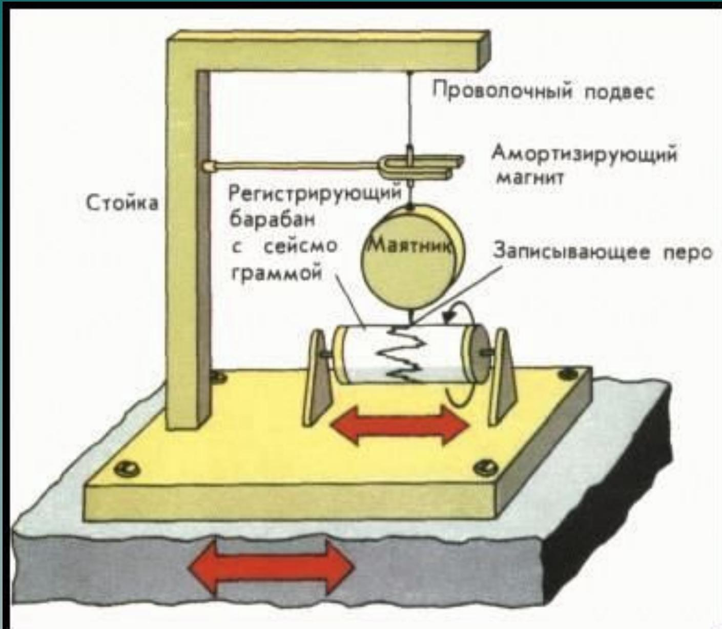
Данный сейсмограф фиксирует вертикальные колебания земли.
