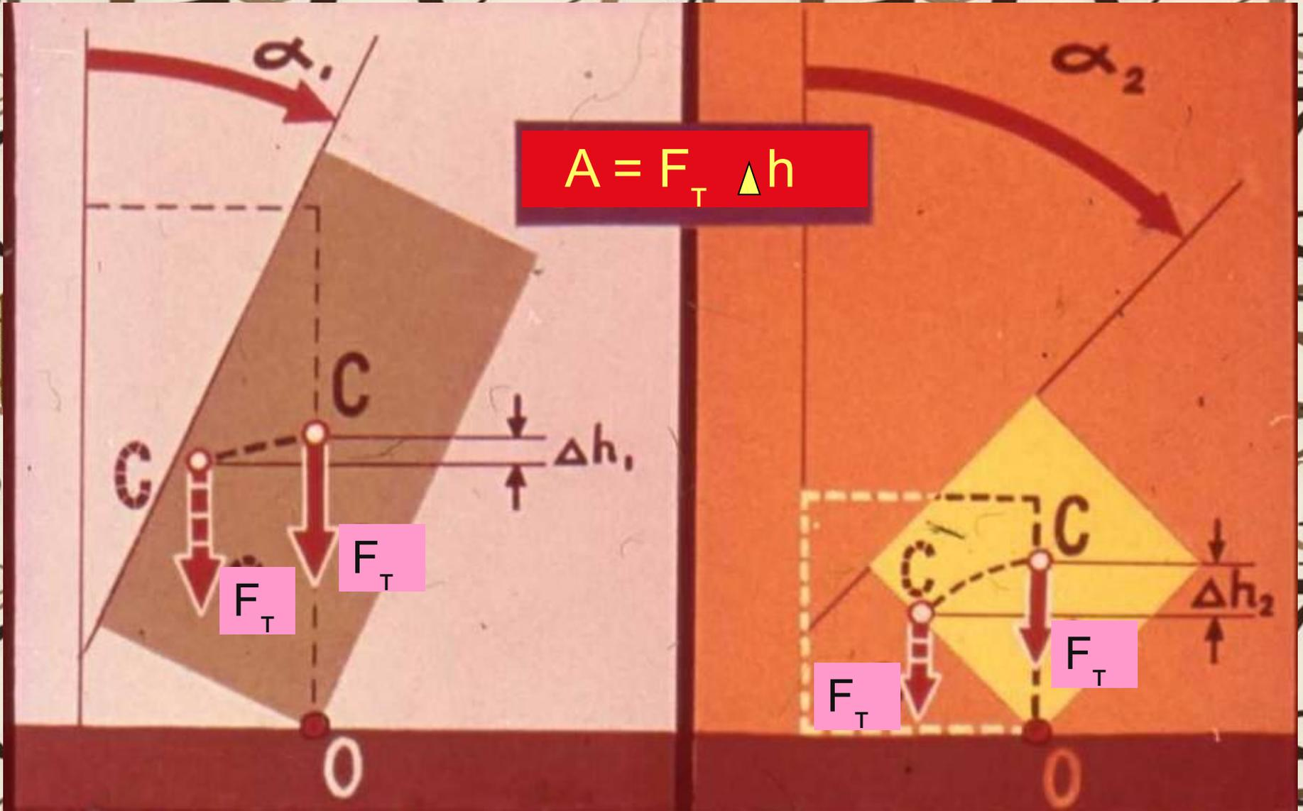
Два тела, у которых одинаковы вес и площадь опоры, но разная высота, имеют разный предельный угол наклона . Если этот угол превысит, то тела опрокидываются.
