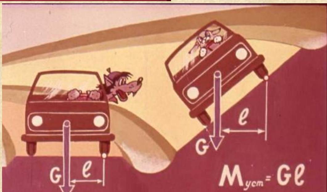
Чтобы увеличить устойчивость машин на поворотах, полотно дороги наклоняют в сторону поворота.
