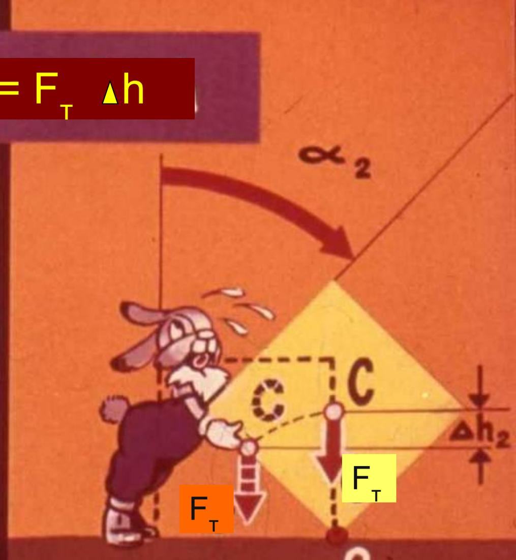
При более низком положении центра тяжести необходимо затратить большую работу для опрокидывания тела. Следовательно **работа по опрокидыванию** может служить мерой его **устойчивости**.
