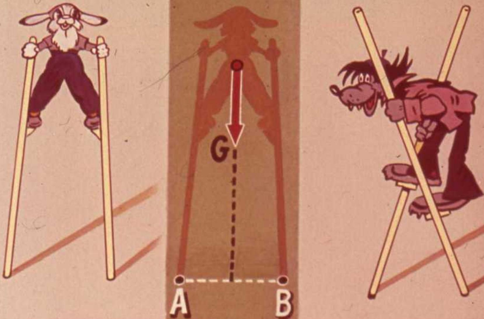
Хождение на ходулях (две точки опоры или линия опоры) осуществляется путём непрерывного смещения центра тяжести относительно линии, соединяющей точки опоры (АВ).
