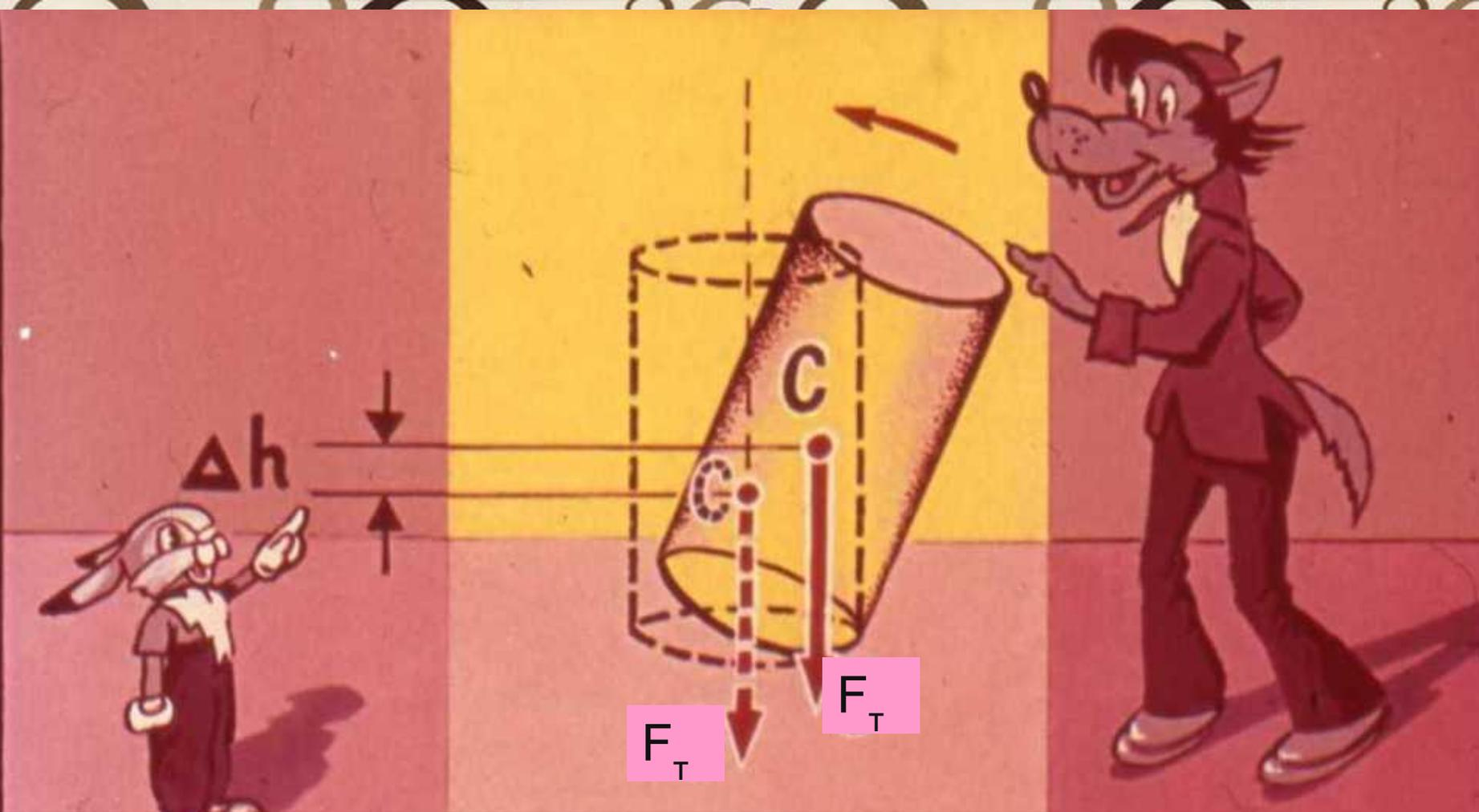
Если при отклонении тела, имеющего площадь опоры, происходит повышение центра тяжести, то равновесие будет устойчивым. При **устойчивом равновесии** вертикальная прямая, проходящая через центр тяжести, всегда будет проходить через площадь опоры.
