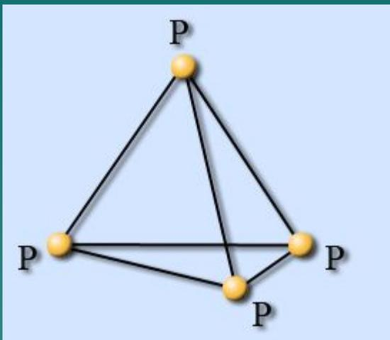
Наиболее распространен белый, или желтый, фосфор. Белый фосфор имеет молекулярную решетку, в узлах которой находятся тетраэдрические молекулы P<sub>4</sub>.
