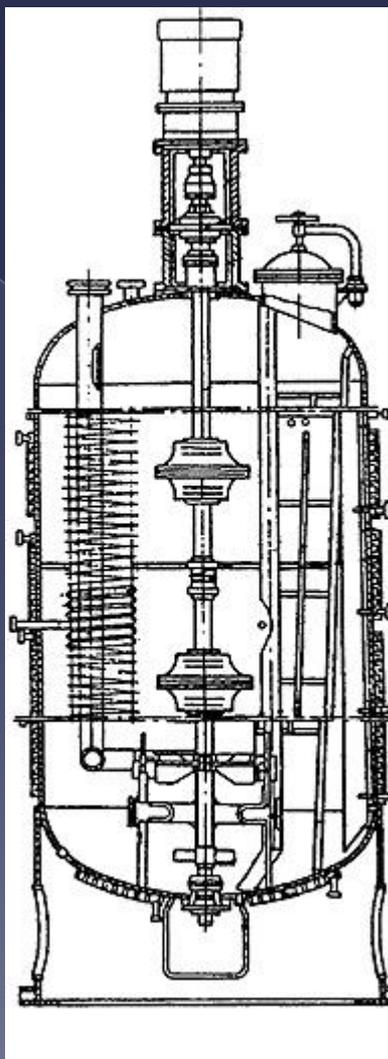
Цилиндрический эрлифтный ферментатор
