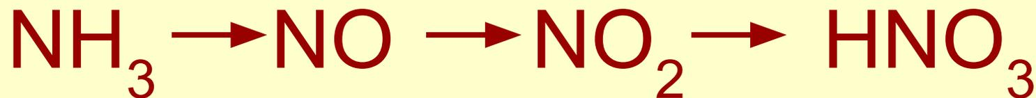
1. Контактное окисление аммиака до оксида азота (II):
