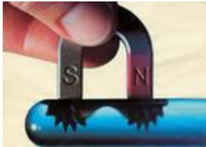
Ферромагнитные жидкости представляют собой коллоидные системы, состоящие из ферромагнитных частиц находящихся во взвешенном состоянии в несущей жидкости
