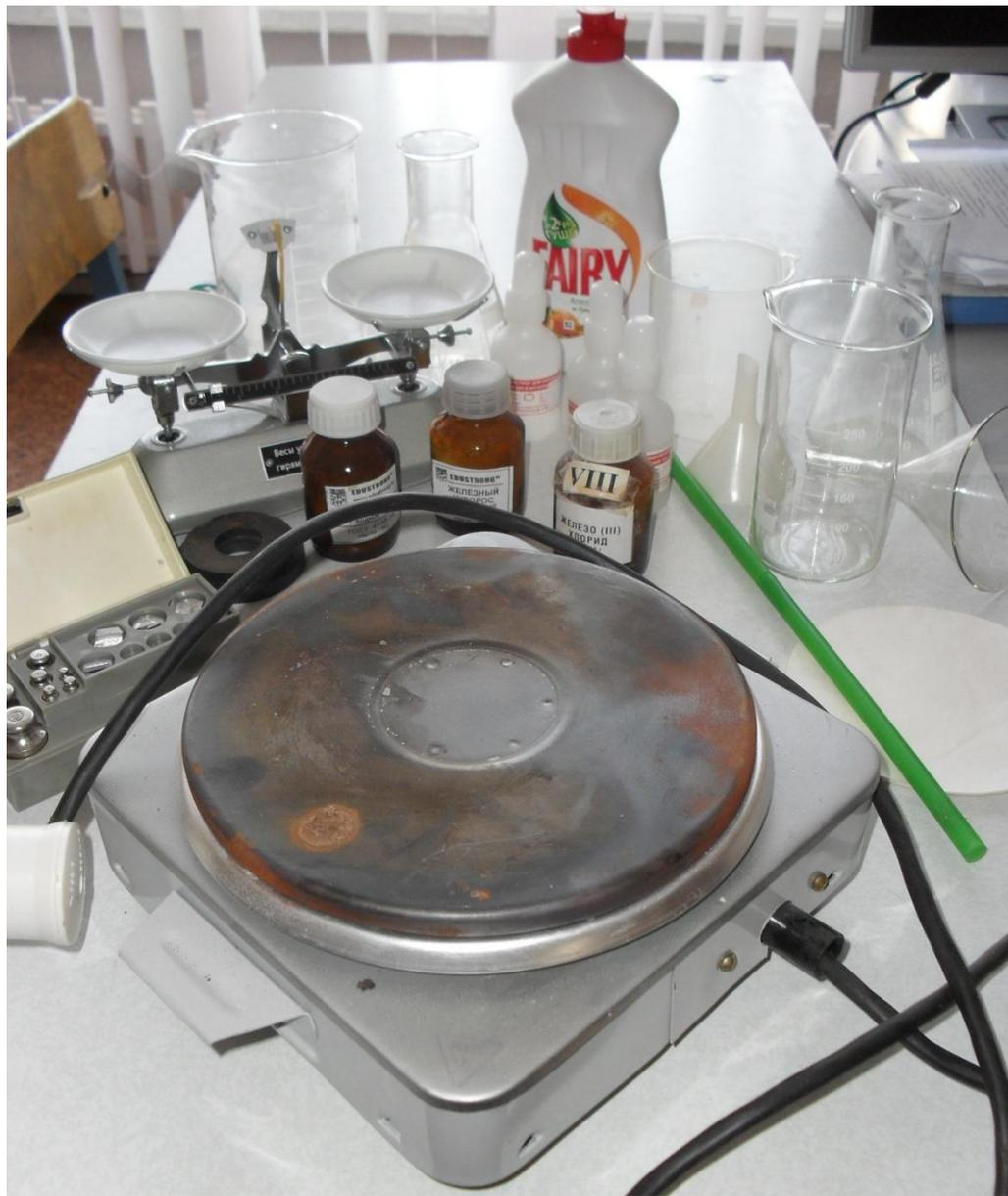
1) В 500 мл дистиллированной воды, при несильном помешивании и подогреве, я растворила 24 грамма хлорида железа (III) и 12 граммов сульфата железа (II) серноокислого железа
