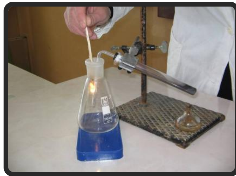
Проверка собранного кислорода
