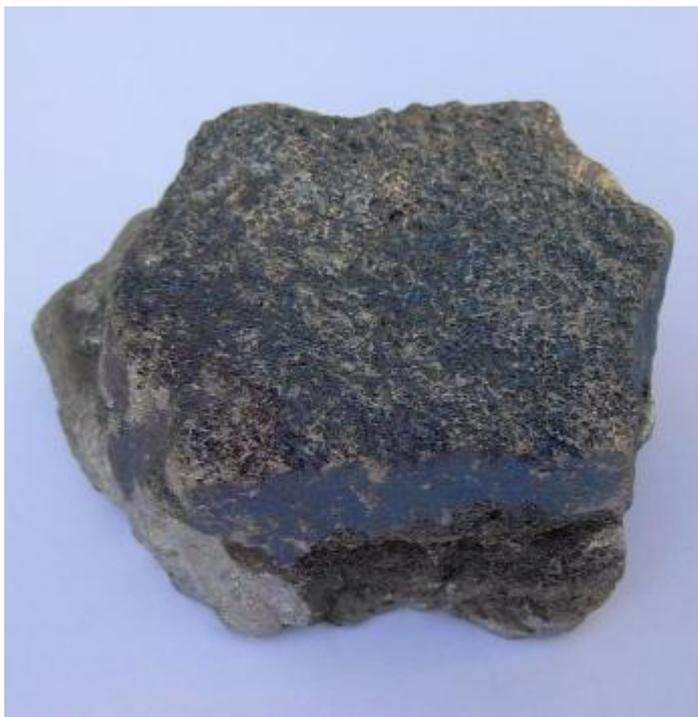
**Феррохром** — сплав железа и хрома (около 60%), основные примеси – углерод (до 5%), кремний (до 8%), сера (до 0,05%), фосфор (до 0,05%). Феррохром применяют для производства легированных сталей.
