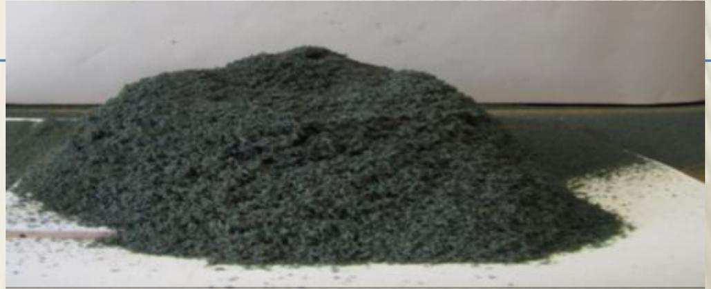
Оксид хрома (III) – тугоплавкий порошок темно-зеленого цвета.
