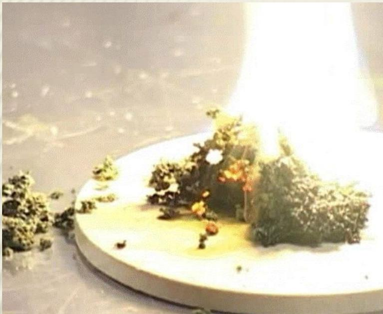
Если поместить оксид хрома на фарфоровую пластинку и капнуть на него несколько капель ацетона, то через несколько секунд ацетон загорается. При этом оксид хрома (VI) восстанавливается до оксида хрома (III), а ацетон окисляется до углекислого газа и воды.
