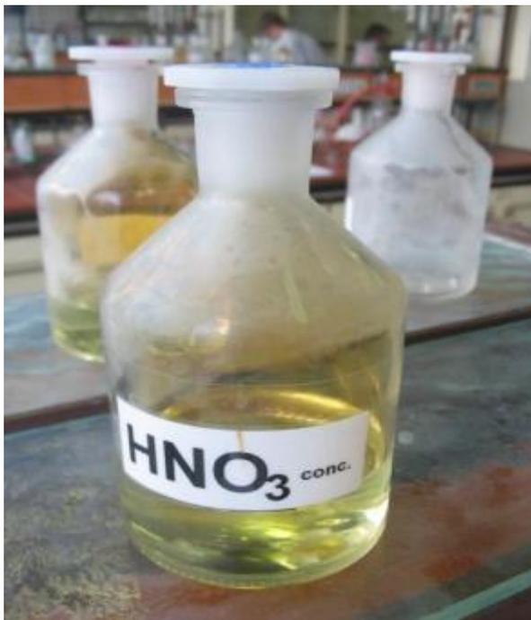
Концентрированные серная и азотная кислоты на холоду *пассивируют* хром
