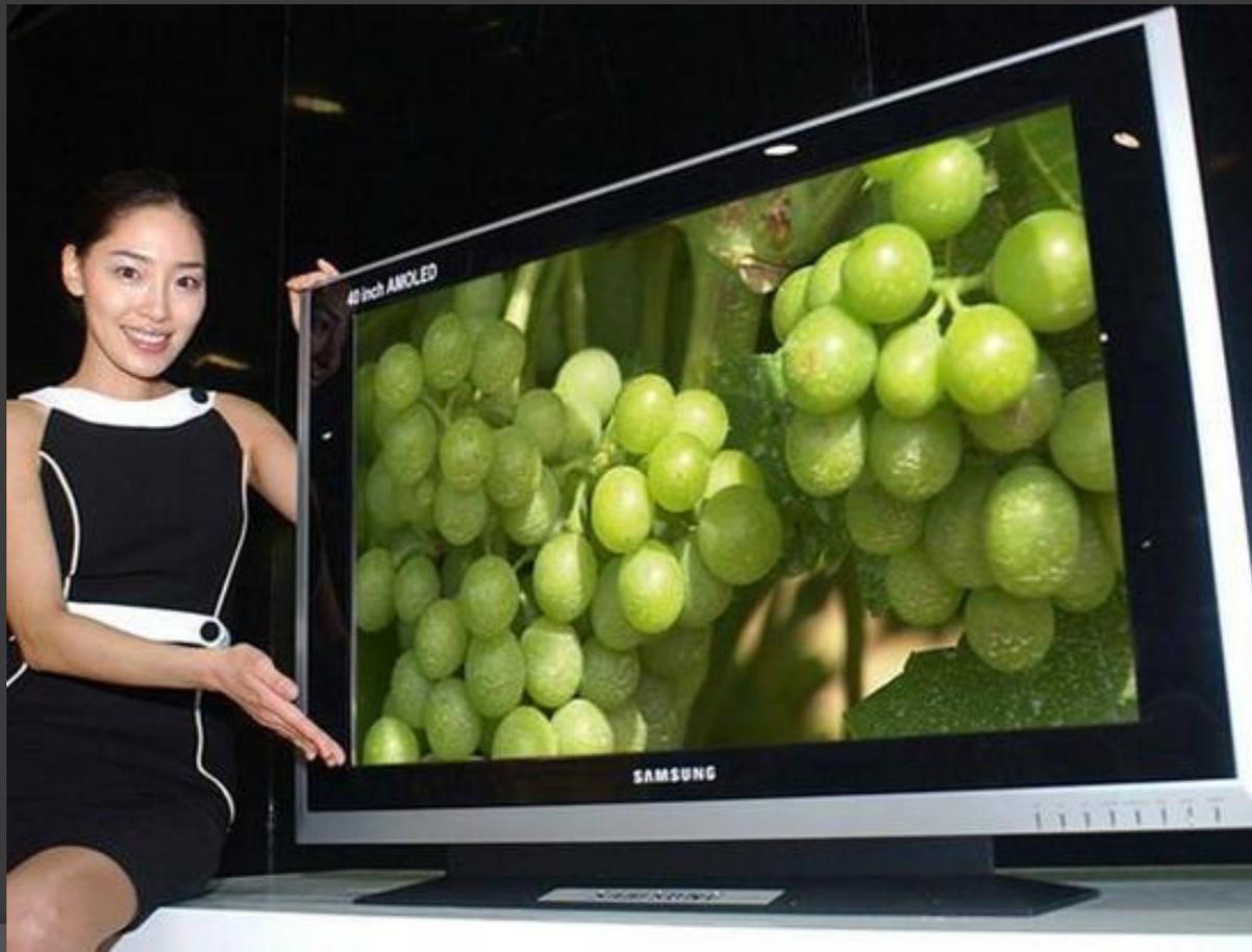
Благодаря совершенствованию светоизлучающих органических веществ верхняя граница рабочей температуры OLED-дисплеев достигла  $100^{\circ}\text{C}$ , что позволяет их эффективно использовать в автомобильной промышленности и других сферах, где температурное воздействие ограничивает применение ранее известных технологий.
