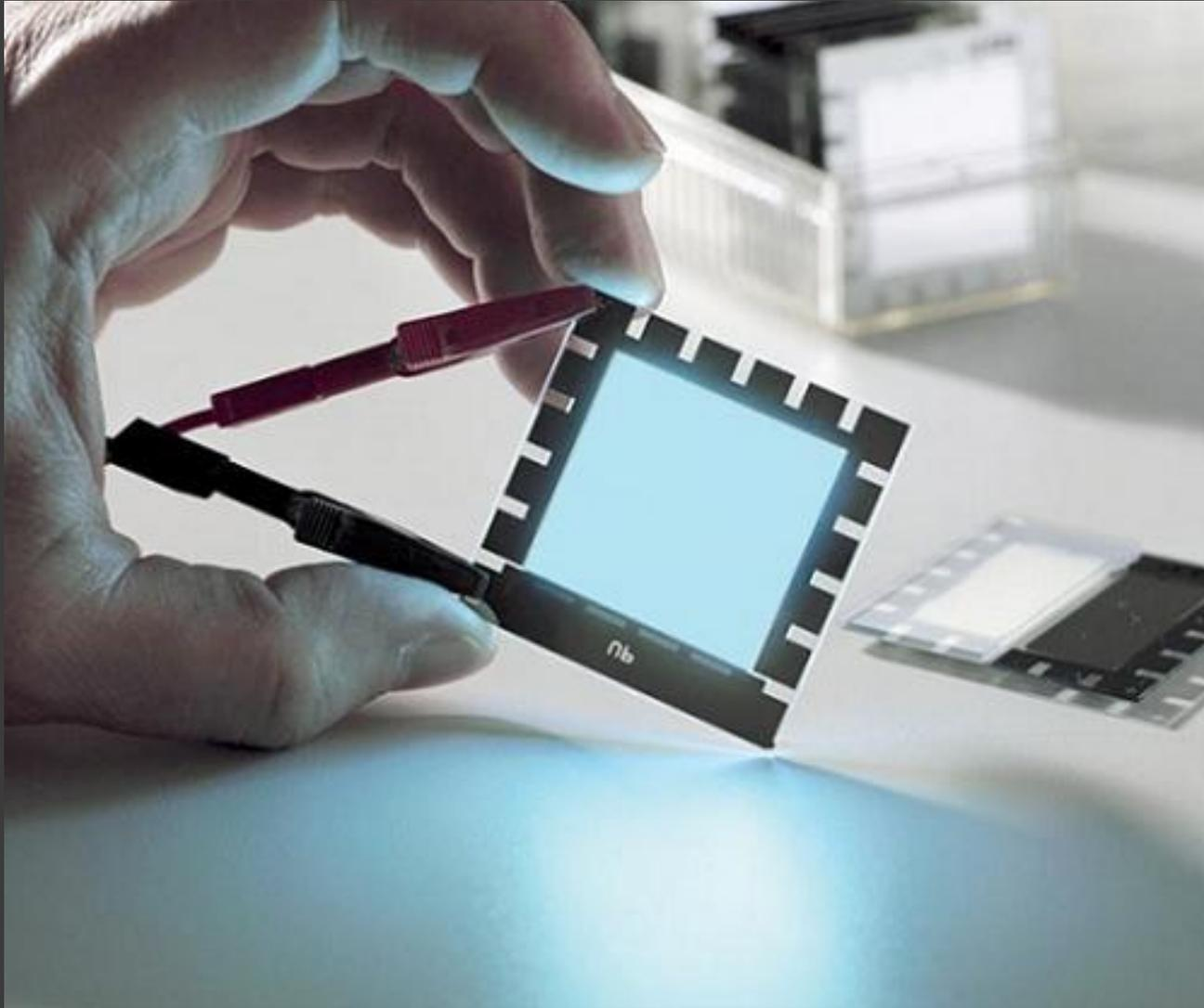
В ней они описали **thin-film (тонкопленочные)** устройства, созданные на основе органических молекул, способные излучать свет при воздействии переменного электрического поля. В соответствии с их данными применяемые материалы значительно превосходили по основным показателям все ранее изучавшиеся вещества подобного рода.
