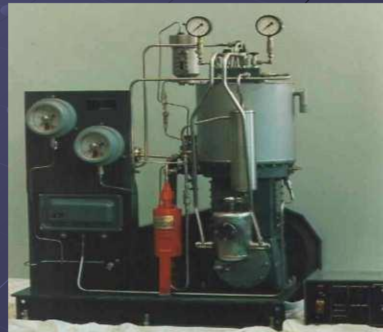
Аппарат для сжимания ацетилена
