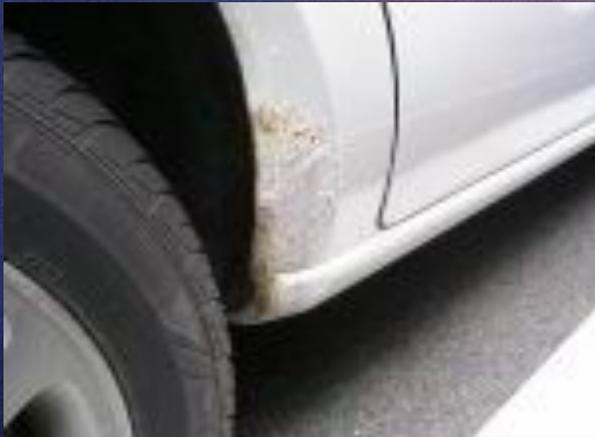
Причиной коррозии является увеличение концентрации иона водорода на поверхности металлов, от которой в большой степени и зависит их окисление:
