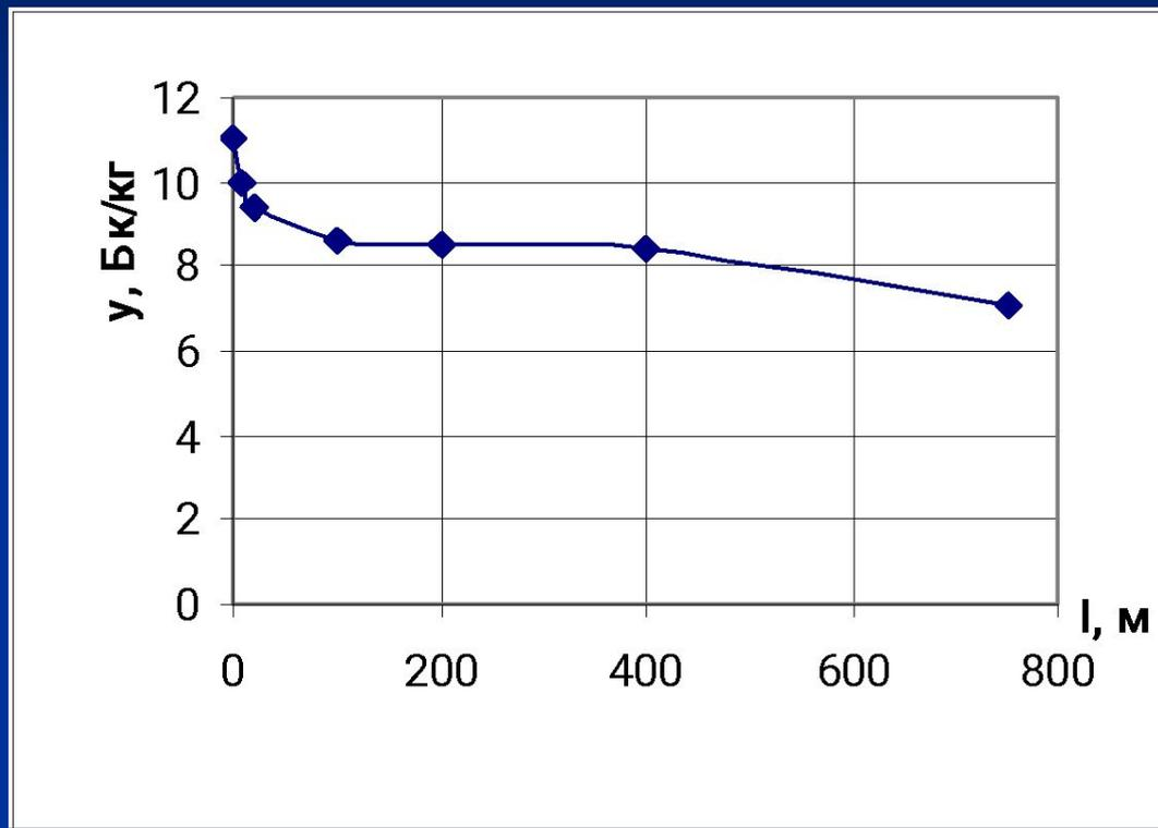
Рисунок 5 - График зависимости удельной гамма-активности от расстояния до террикона шахты Дувана
