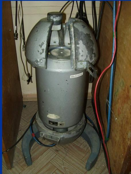
Рис. 4-Детектор гамма –спектрометра и его защита
