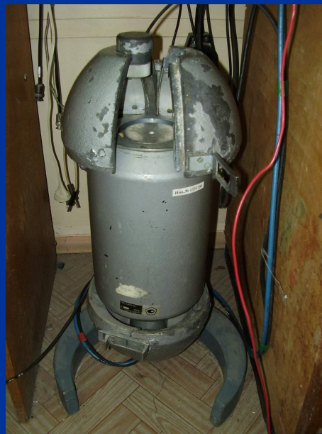
Рис. 4-Детектор гамма –спектрометра и его защита
