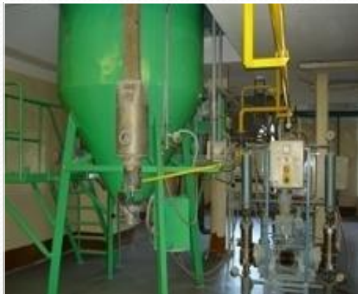
Получение гранулята Гранулятор фирмы Niro A/S
