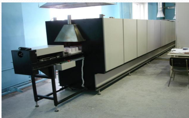
Оплавление глазури печь электрическая GMQ 4030-15 NM (Китай)
