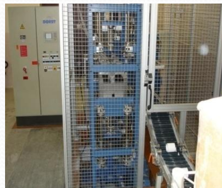
Изостатическое прессование пресс PI-80Z (Dorst,Германия)
