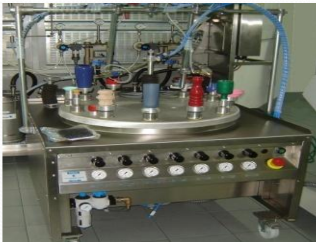
Нанесение глазури установка MP-400 (Германия)
