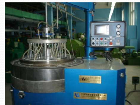
Двусторонняя шлифовка X61-850B1 (Китай)
