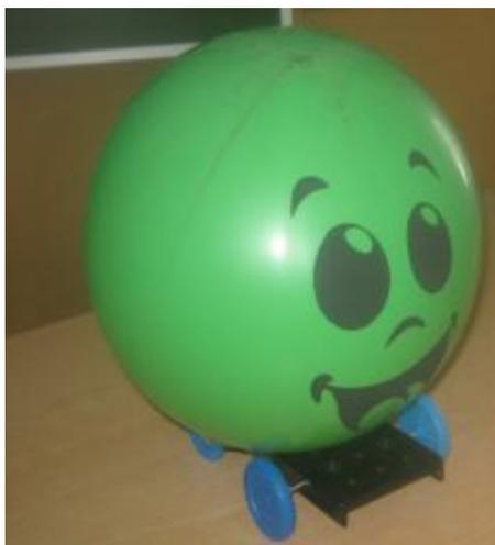
На тележке (игрушечной машинке) закрепите скотчем надувной шарик. На место, где шарик, вы предполагаете проткнуть, наклейте кусочек скотча. В этом случае шарик сразу не лопнет, а будет сдуваться равномерно, и тележка начнёт двигаться, постепенно набирая скорость.
