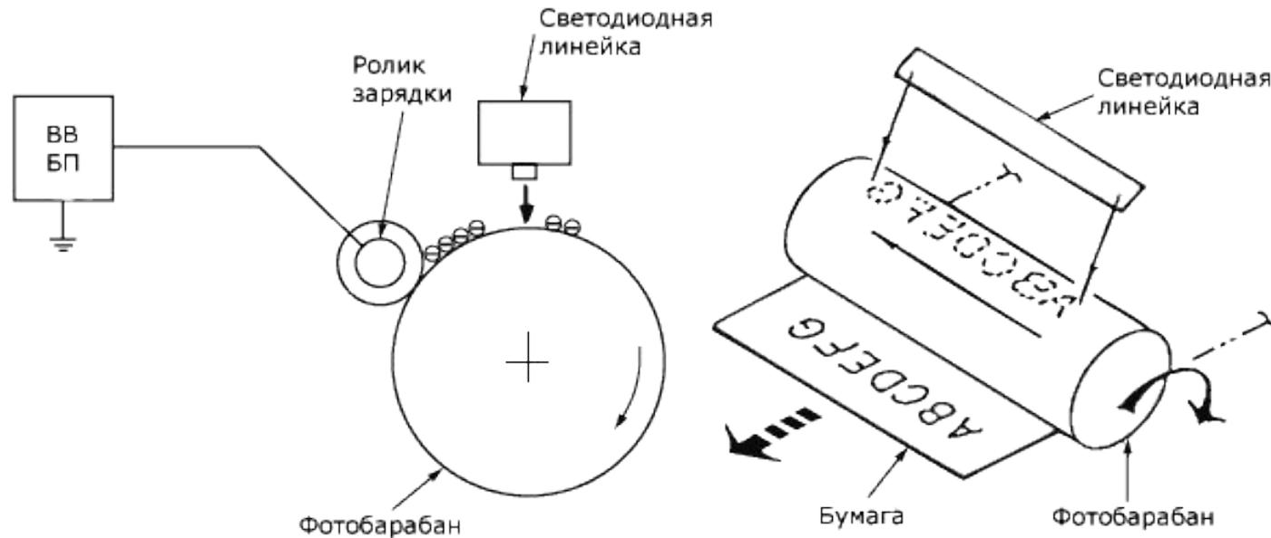
На тех местах, куда попадает луч света, отрицательный заряд снимается, становясь нулевым. Тем самым на поверхности фотобарабана создаётся электростатическое изображение будущего отпечатка.
