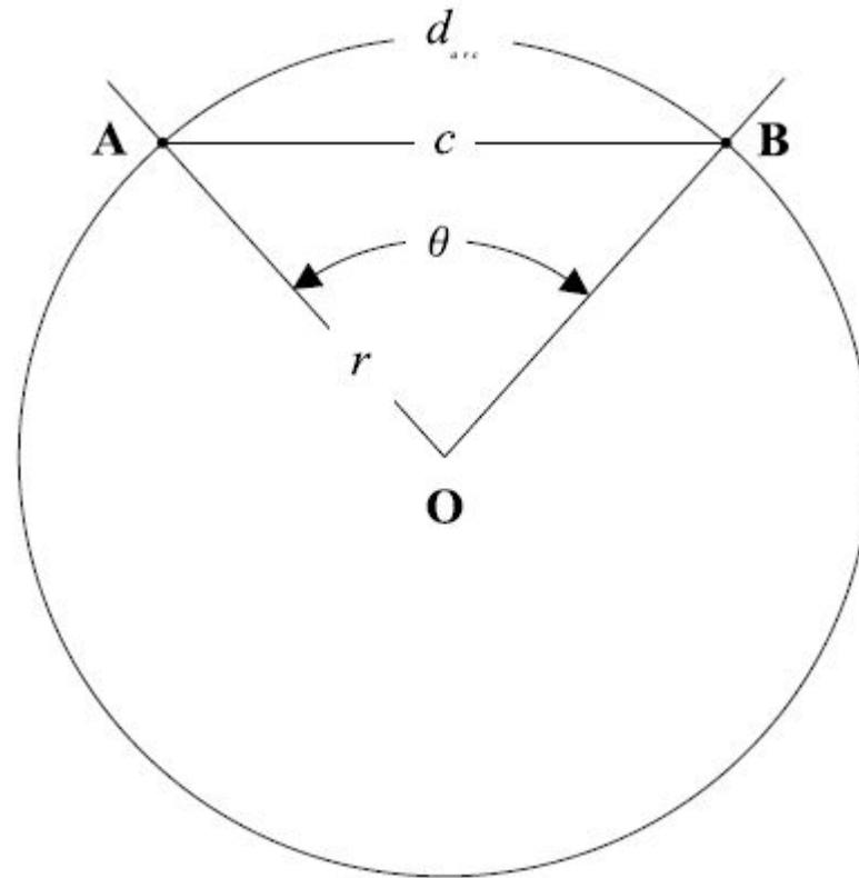
Зависимость длины хорды от длины дуги на земной поверхности
