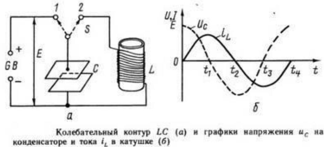
За счет энергии, накопленной в магнитном поле катушки, ток будет продолжать течь в том же направлении, постепенно уменьшаясь по величине. При этом происходит перезарядка конденсатора, и нижняя пластина приобретает положительное напряжение.
