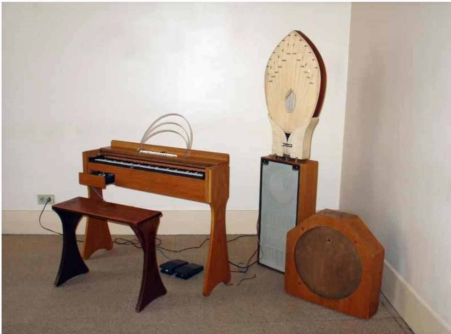
Инструмент имеет 7-октавную клавиатуру фортепианного типа, а также нить с кольцом, надеваемым на указательный палец правой руки. В левой части инструмента расположена кнопка, играющая роль смычка.
