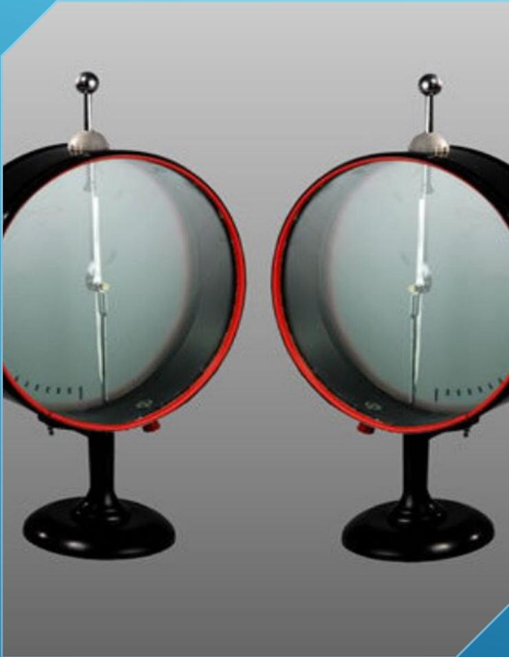
Электрометр представляет собой металлический цилиндрический корпус, Передние и задние стенки которого стеклянные. Корпус закреплён на подставке. Через изолирующую втулку внутри корпуса сверху проходит металлическая трубка, Заканчивающиеся стержнем с установленной на нём легко- подвижной стрелкой, отклонение которой определяется величиной заряда. Стрелка может вращаться вокруг горизонтальной оси. Внутри корпуса установлена шкала электрометра.
