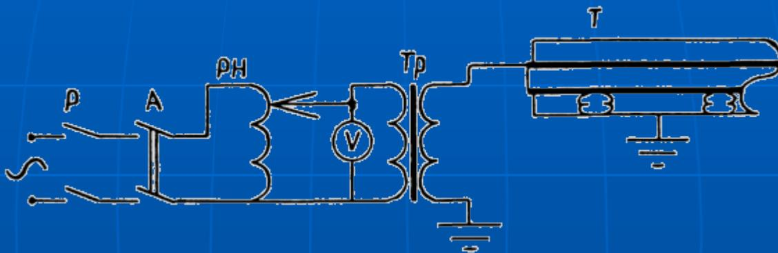
**Рис. 1. Схема испытаний токопроводов повышенным напряжением промышленной частоты:**
