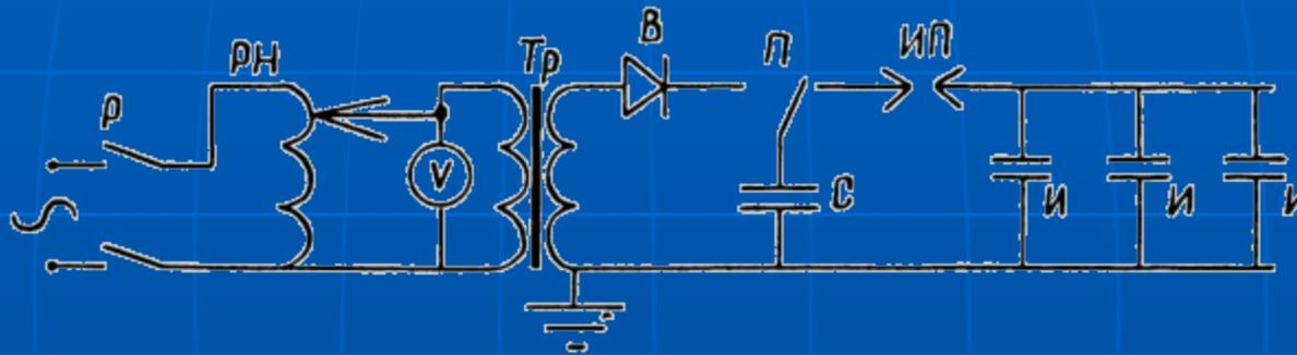
**Рис. 2. Схема выявления дефектных изоляторов токопроводов:**
