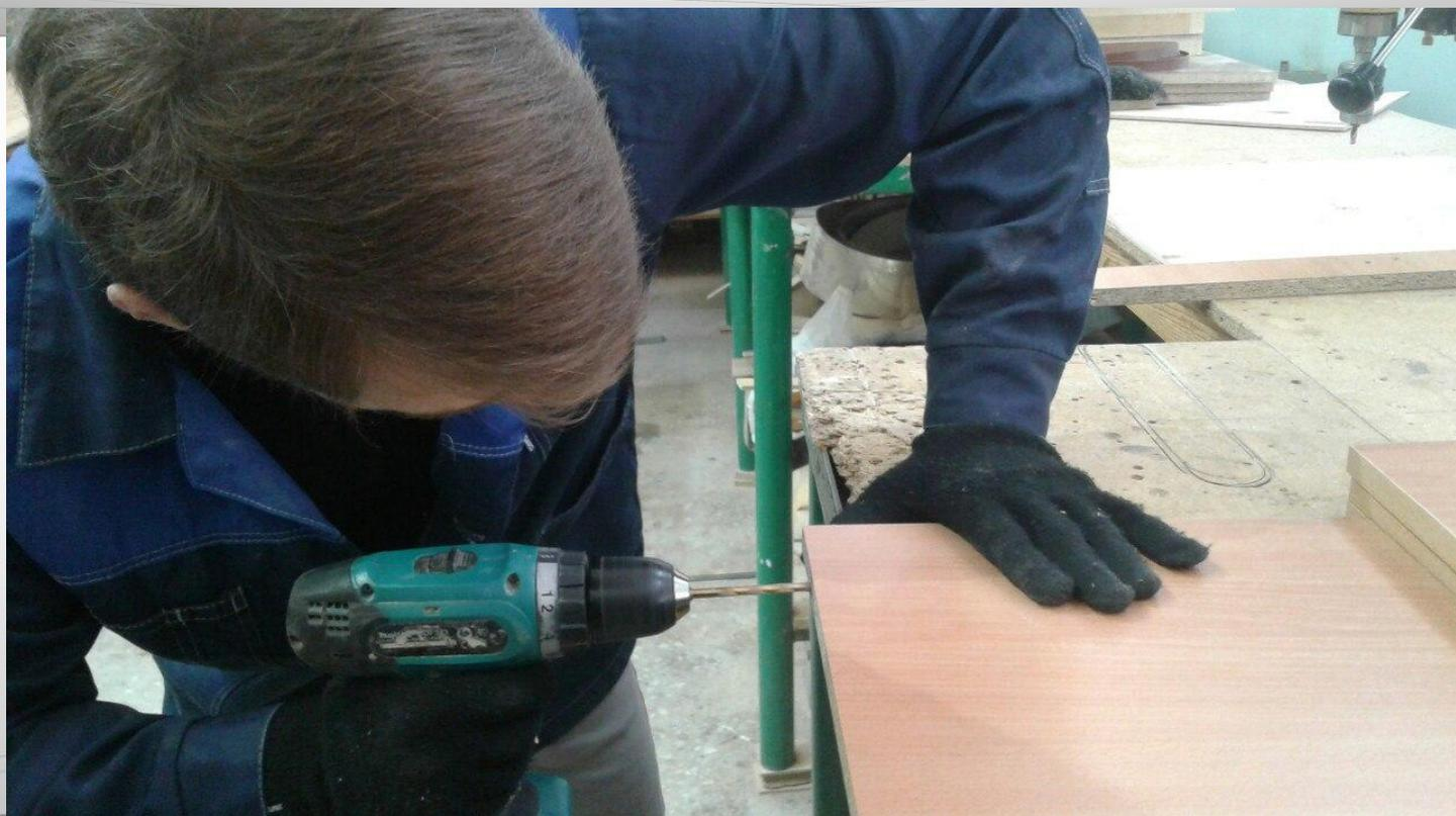
Для соединения деталей Компьютерного стола выполнил разметку и присадку деталей на сверлильном станке, сборку производил применяя шуруповерт. Фурнитура – опора колесная, евровинт, уголки меб., саморезы 3,5×16.
