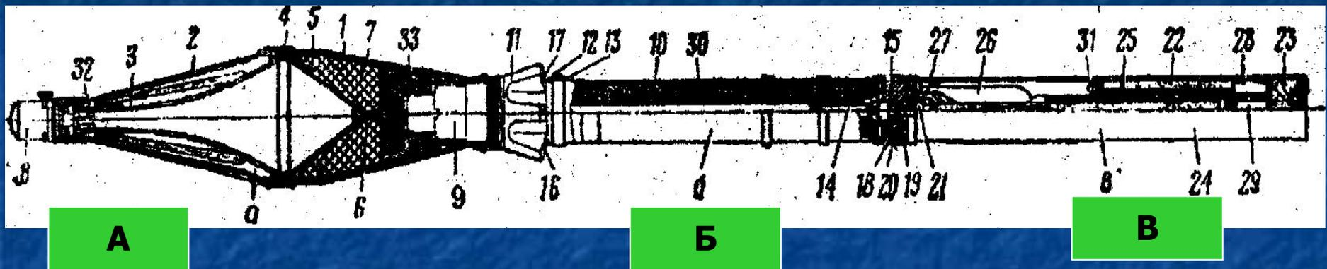
Выстрел ПГ-7В состоит из противотанковой гранаты и порохового заряда.
