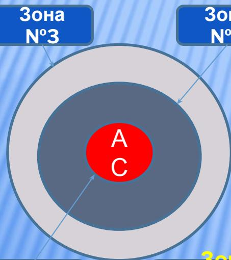
**Зона №1** – зона общей упреждающей эвакуации населения, которая должна проводиться при возникновении начальной стадии ранней фазы аварии (НС РФА), в основном, на реакторах первого поколения. Зона представляет собой круг с радиусом в зависимости от типа и мощности реактора. (7 -12 км)
