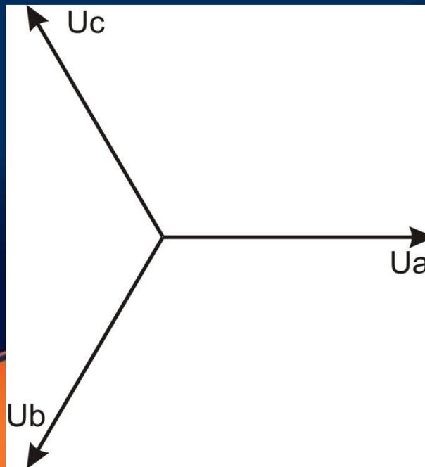
а. построим линейные напряжения  $\dot{U}_{AB} = \dot{U}_A - \dot{U}_B$ ;  $\dot{U}_{BC} = \dot{U}_B - \dot{U}_C$ ;
