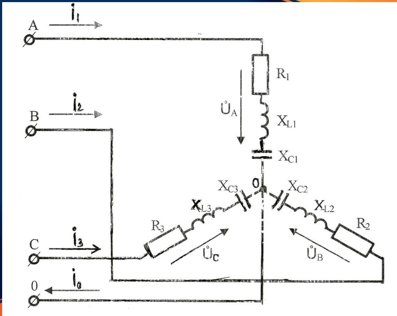
2. Определим комплексы фазных напряжений, принимая, что  $\dot{U}_A$  направлен по действительной оси. При соединении приемников «звездой» с нулевым проводом независимо от величины сопротивления фаз приемника величина (модуль) фазного напряжения меньше линейного:
