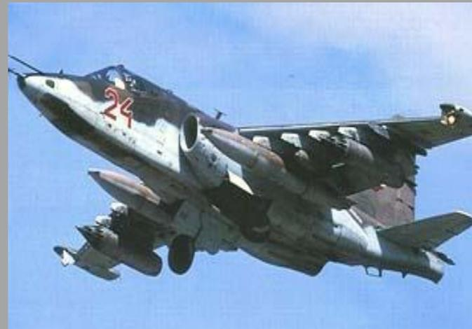
На вооружении частей ША находится самолет Су-25. Он предназначен для решения разнообразных задач в интересах сухопутных войск путем нанесения ударов в простых и сложных метеоусловиях по подвижным малоразмерным бронированным целям в условиях сильного противодействия средств ПВО противника. Наряду с этим самолет способен уничтожать мосты и переправы, полевые укрепления, комплексы ПВО, корабли, боевые вертолеты и транспортные самолеты. Боевая живучесть обеспечивается мощным
