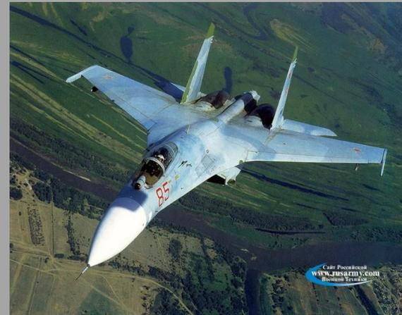
Обеспечивается обнаружение и сопровождение воздушных целей как в свободном пространстве, так и на фоне земли, сопровождение "на проходе" до 10 целей, опознавание и определение наиболее опасной из сопровождаемых целей и выбор ее для атаки, непрерывная пеленгация атакуемой, цели по углам и дальности в дальнем и ближнем маневренном бою, а также подсвет атакуемой цели.
