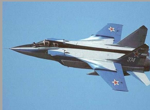
Самолет МиГ-31 представляет собой двухместный сверхзвуковой истребитель дальнего действия, который предназначен для использования в системе ПВО страны. Он способен выполнять длительное патрулирование и вести борьбу со всеми классами аэродинамических целей (в том числе малозаметными крылатыми ракетами, вертолетами и высотными скоростными самолетами) в любое время суток, в сложных погодных условиях, при интенсивном ведении боя.
