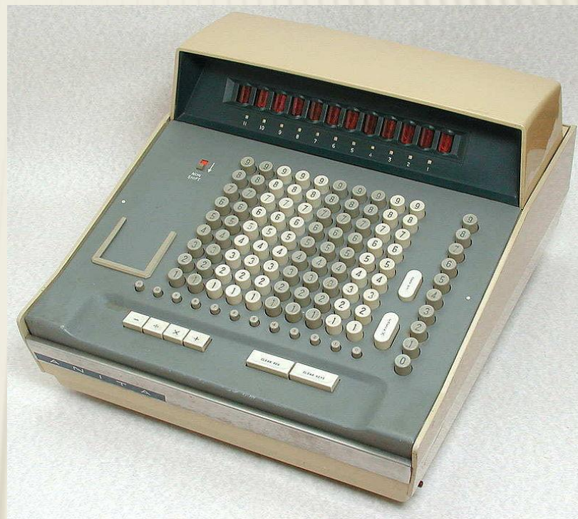
Первый полностью электронный настольный калькулятор (британский ANITA Mark VII )
