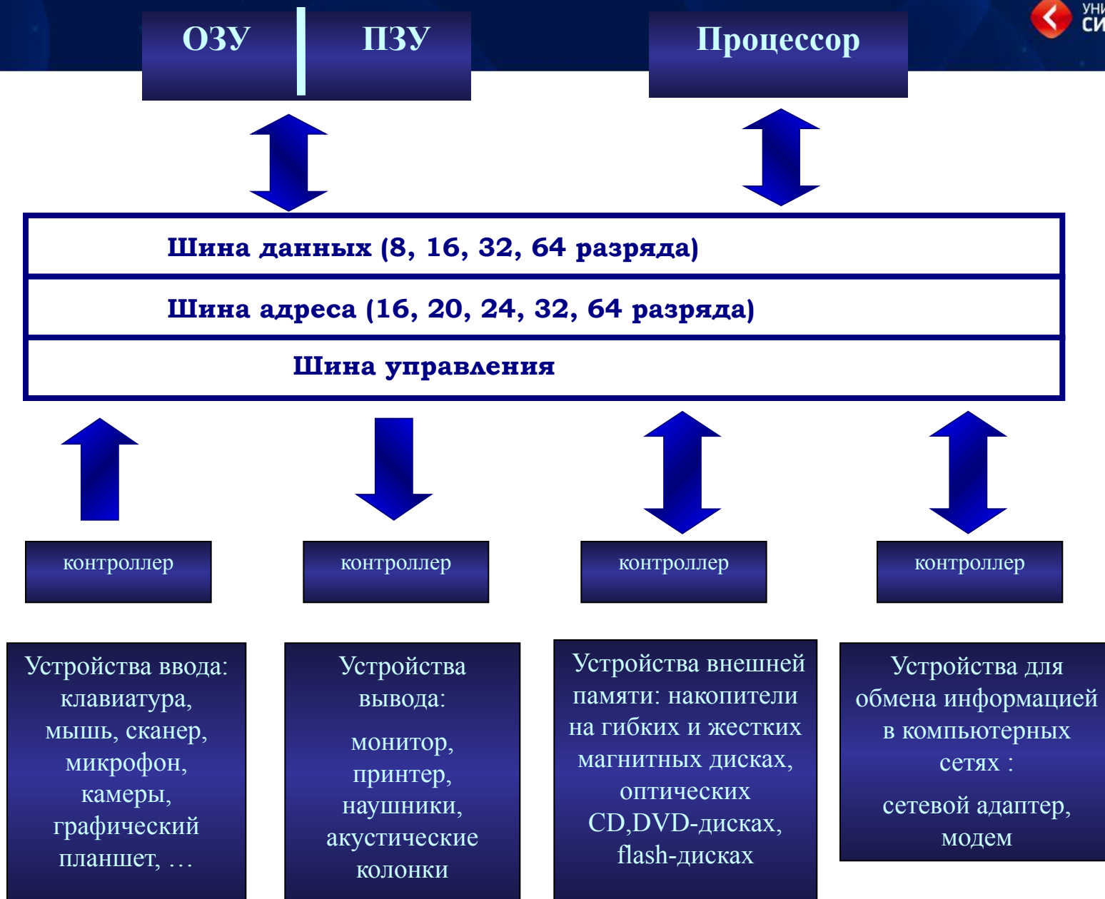
Функциональная схема компьютера, построенного по магистрально-модульному принципу
