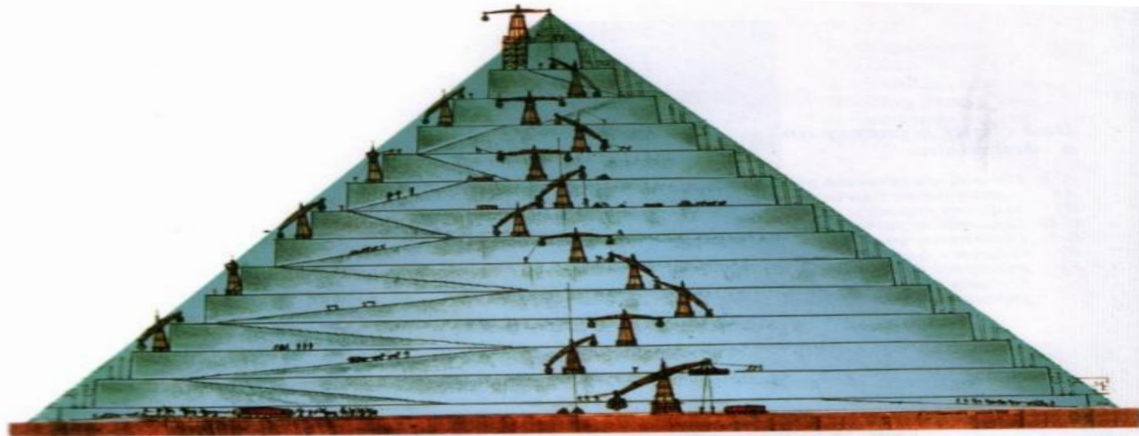
Рис. 20. Монтаж каменных блоков пирамиды с помощью подъемных машин
