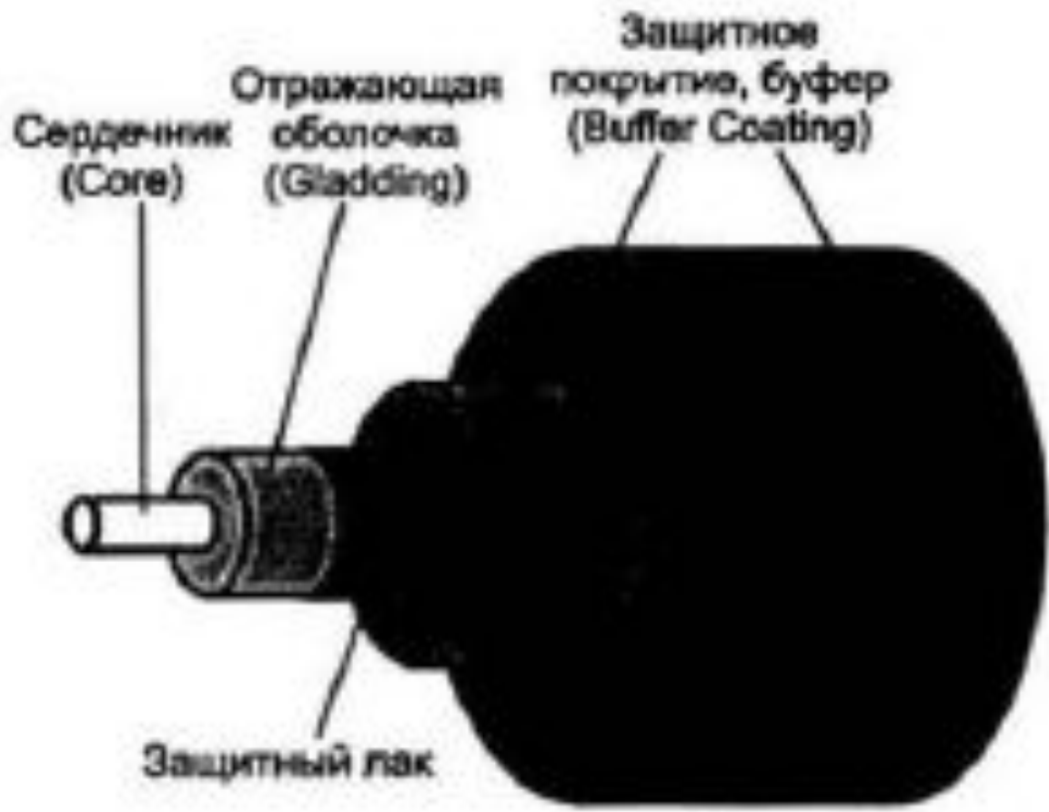
Рис. 3.7. Конструкция оптоволоконного кабеля
