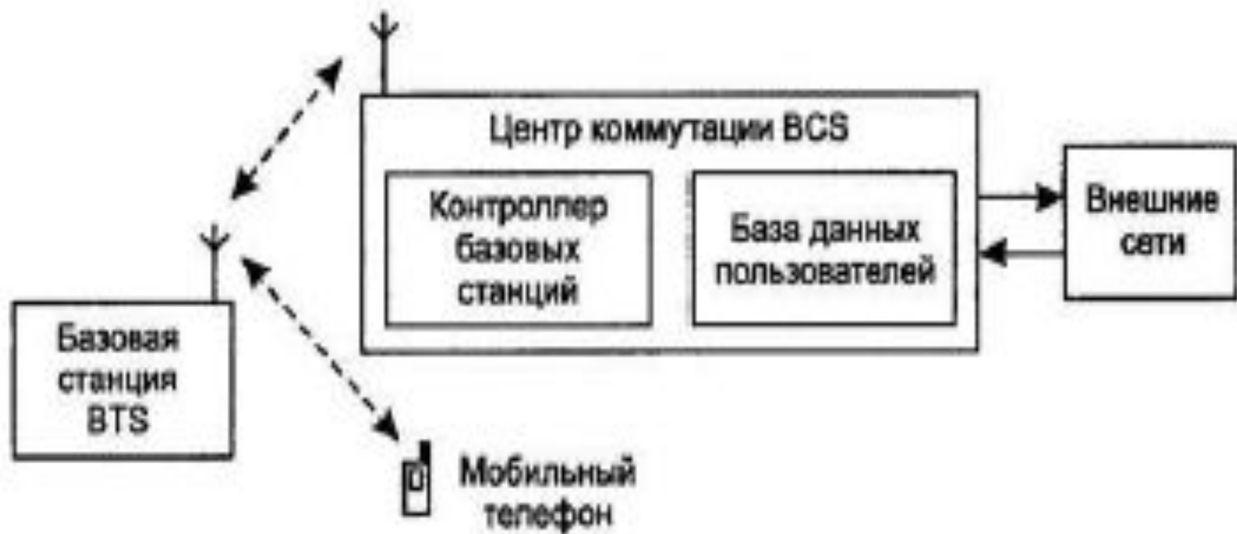
Рис. 3.9. Схема сотовой телефонной связи
