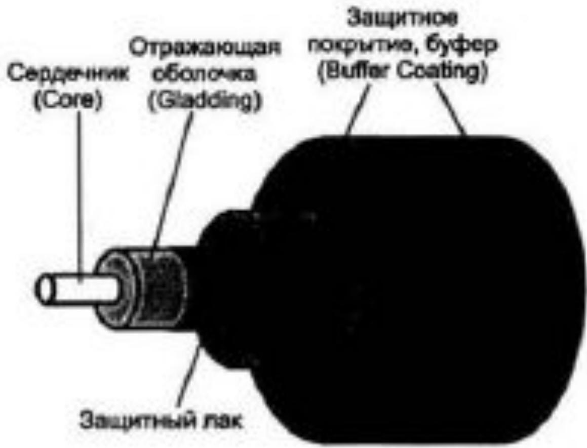
Рис. 3.7. Конструкция оптоволоконного кабеля
