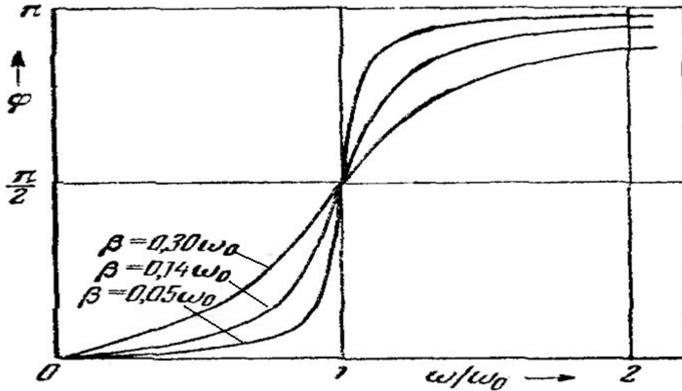
Зависимость  $\varphi$  от  $\omega$  при различных значениях коэффициента затухания  $\beta$ . Частоте  $\omega_0$  соответствует  $\varphi = \pi/2$ .
