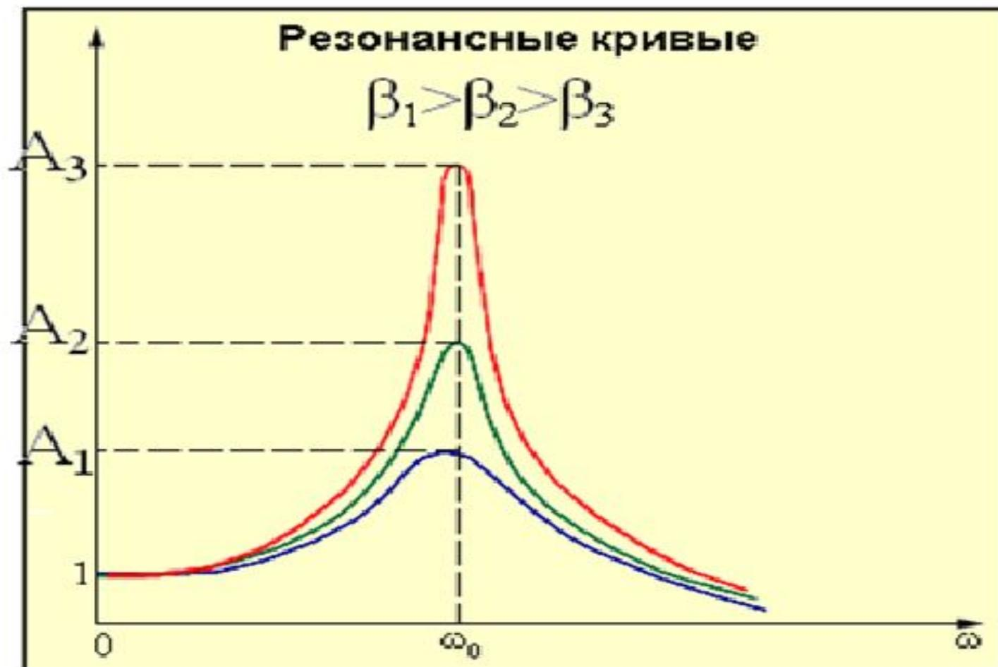
При очень большом затухании выражение для резонансной частоты становится мнимым. Это означает, что при этих условиях резонанс не наблюдается – с увеличением частоты амплитуда вынужденных колебаний монотонно убывает.
