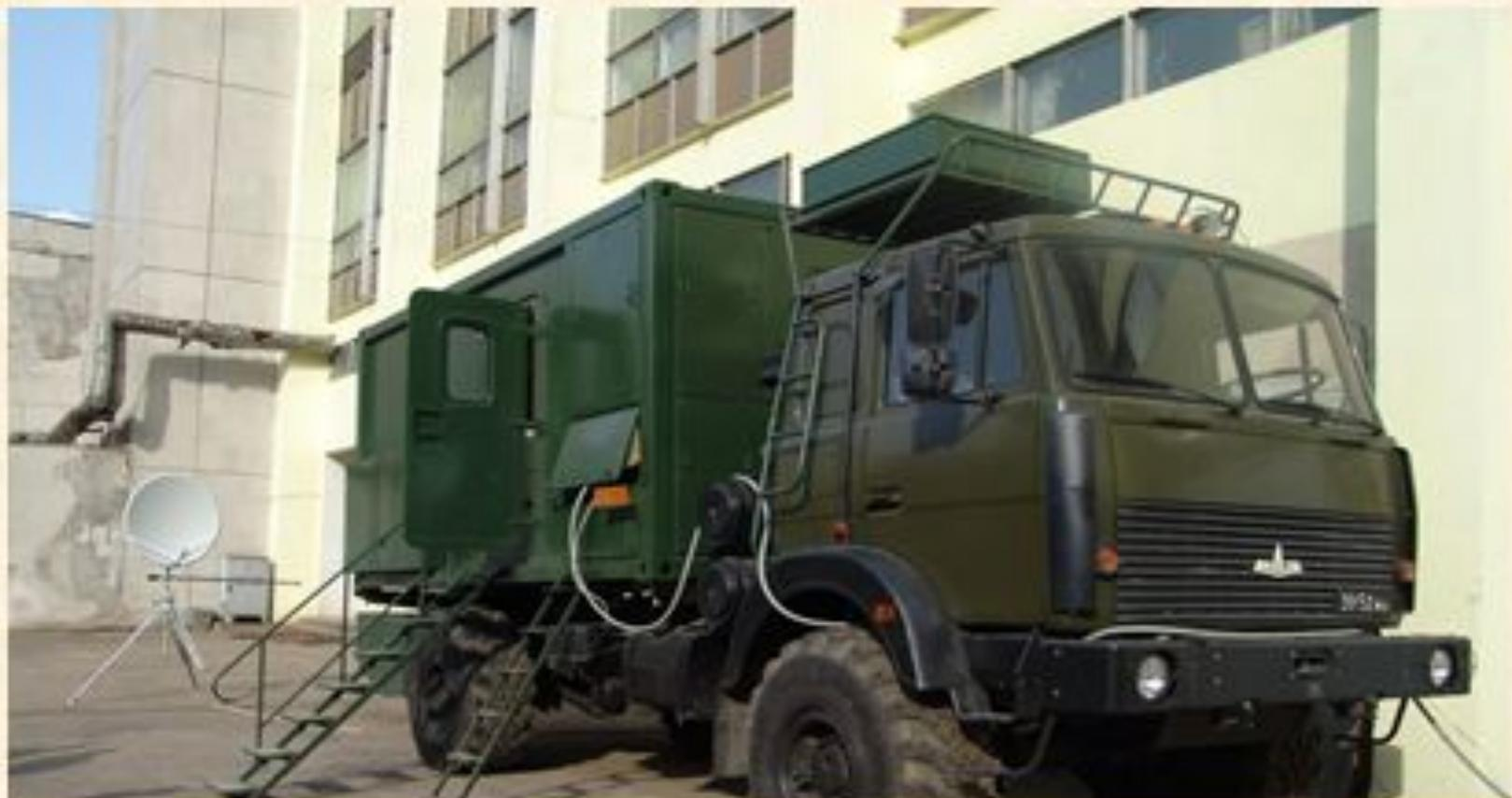
**Подвижный центр информации бригады на отечественной базе МАЗ – позволяет производить сбор, обработку, обобщение и анализ информации, ее тиражирование и передачу по каналам спутниковой связи (в полевых условиях).**
