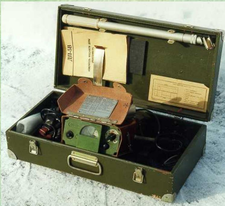
Измеритель мощности дозы ДП-5В предназначен для измерения **мощности экспозиционной дозы** на радиоактивно загрязненной местности и радиоактивного загрязнения поверхностей различных объектов по гамма-излучению. Кроме того, измеритель позволяет **обнаруживать бета-излучение**.
