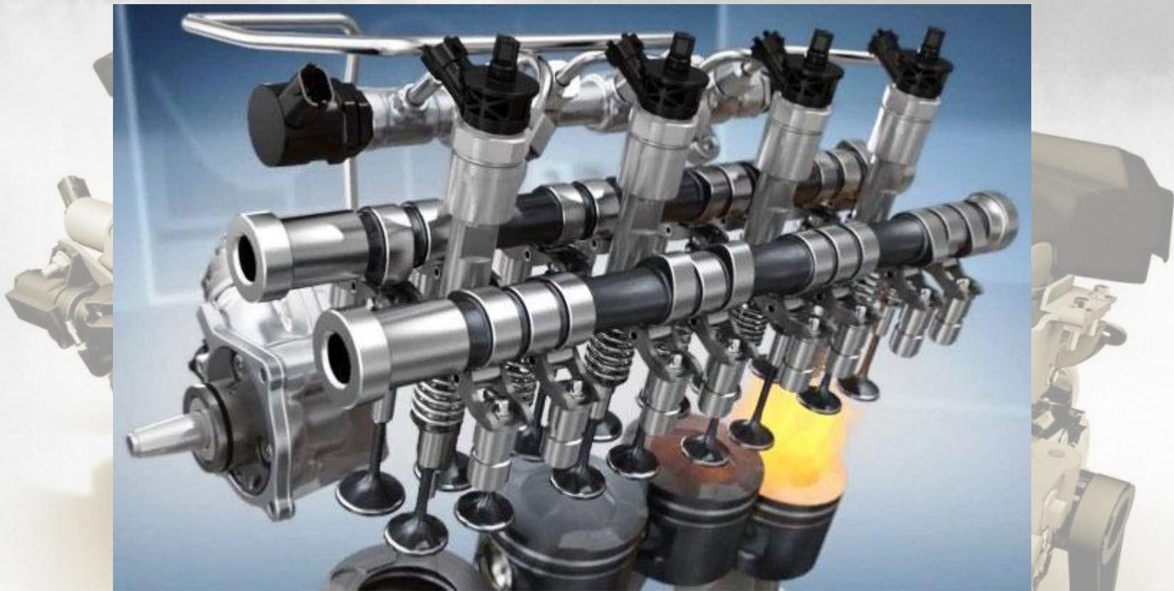
**Газораспределительный механизм** предназначен для своевременного впуска в цилиндры горючей смеси (карбюраторные двигатели) или очищенного воздуха (дизели) и выпуска отработавших газов.
