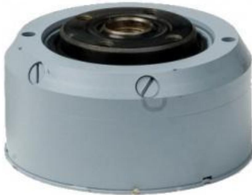
**Муфта опережения впрыска** служит для автоматического изменения момента начала подачи топлива насосом в зависимости от изменения частоты вращения двигателя. При увеличении частоты вращения, для того чтобы топливо, подаваемое в цилиндры, успевало своевременно сгорать и двигатель развивал наибольшую мощность, необходимо увеличивать угол опережения впрыска топлива, а при уменьшении частоты вращения — уменьшать.
