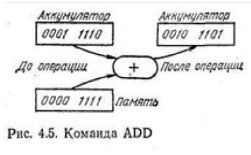
На рис. 4.5 приведен пример использования команды сложения ADD Л. Содержимое (А) аккумулятора ( $0001\ 1110_2$ ) складывается с содержимым (М) памяти ( $0000\ 1111_2$ ), сумма ( $0010\ 1101_2$ ) помещается в аккумулятор (справа). Заметим, что содержимое ячейки памяти не изменилось, тогда как содержимое аккумулятора стало другим.
