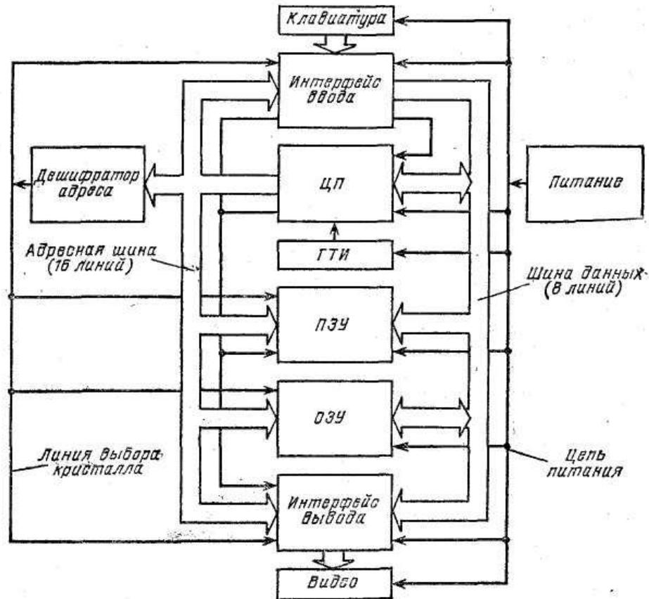
Рис. 4.1. Архитектура микро-ЭВМ
