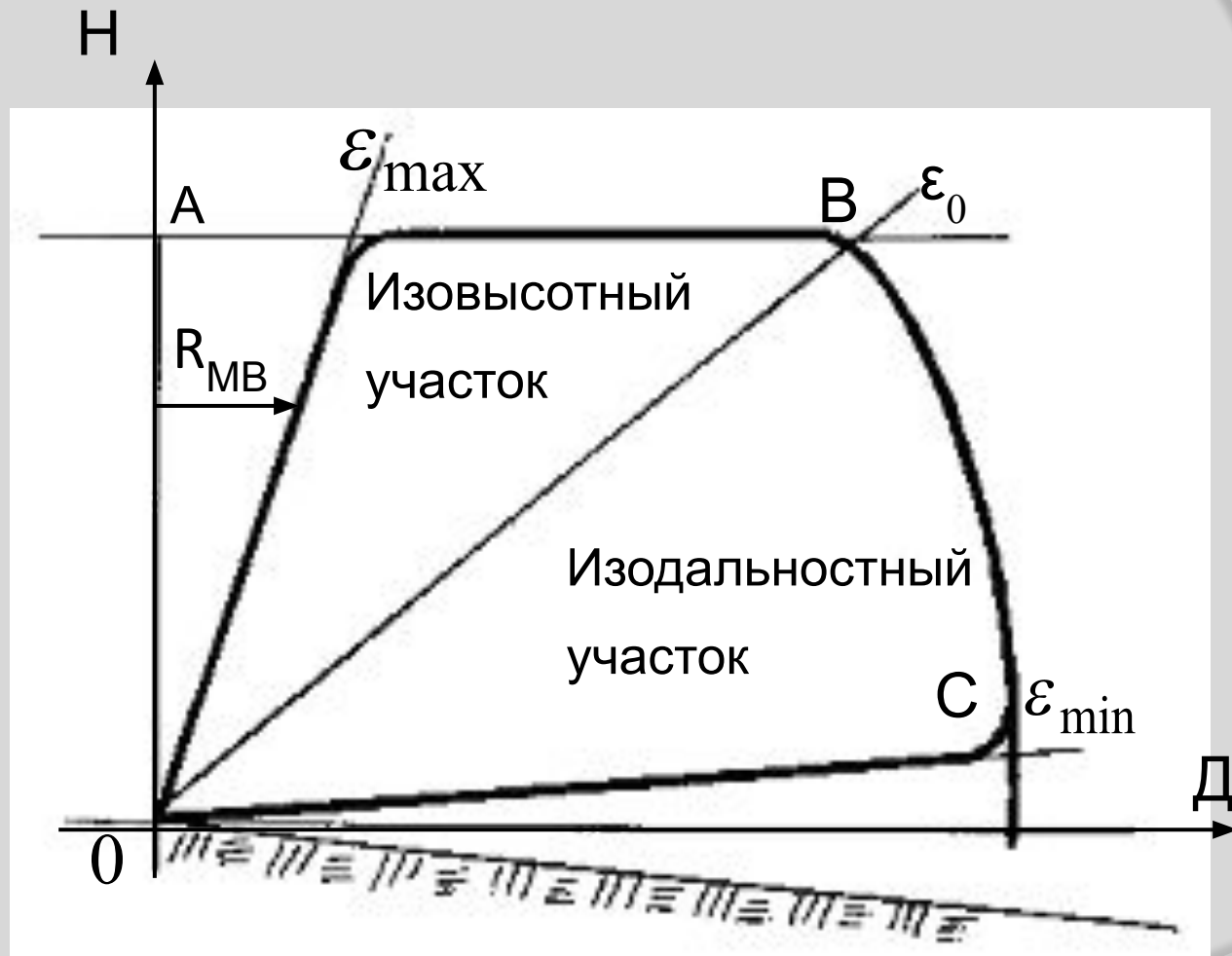
Рис. Сечение зоны обнаружения радиолокационной станции в угломестной плоскости
