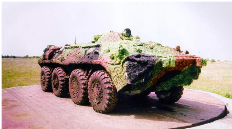
Маскирующее покрытие для БВТ на основе полимерных пен
