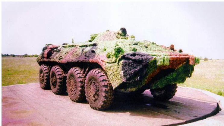
Маскирующее покрытие для ВВТ на основе полимерных пен
