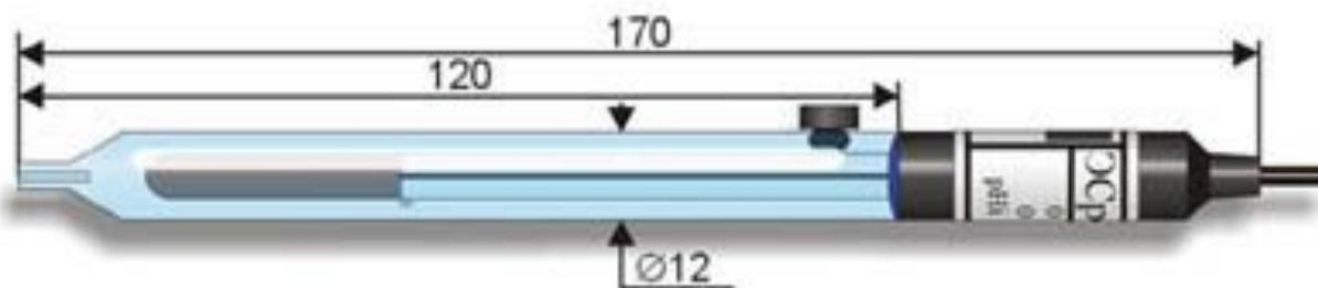
Сурьмяный электрод относится к группе металлоксидных электродов, изготовлен из литой сурьмы, поверхность которой на воздухе покрывается оксидами. Если такой электрод поместить в раствор, содержащий ионы гидроксида (или ионы водорода), то на электроде устанавливается равновесие потенциал определяющей реакции:
