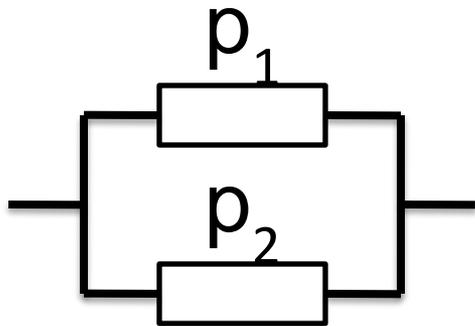
$$r_{\text{ЭКВ}} = r_1 + r_2 - r_1 r_2$$
