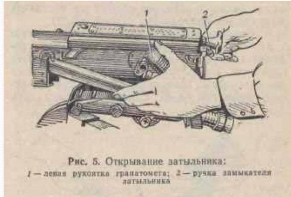
Рис. 5. Открывание затыльника:
