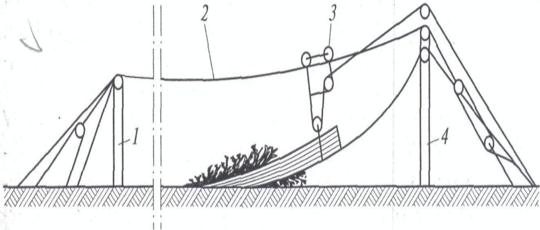
Рис. 1.11. Схема полуподвесной канатной трелевочной установки с несущим канатом:
