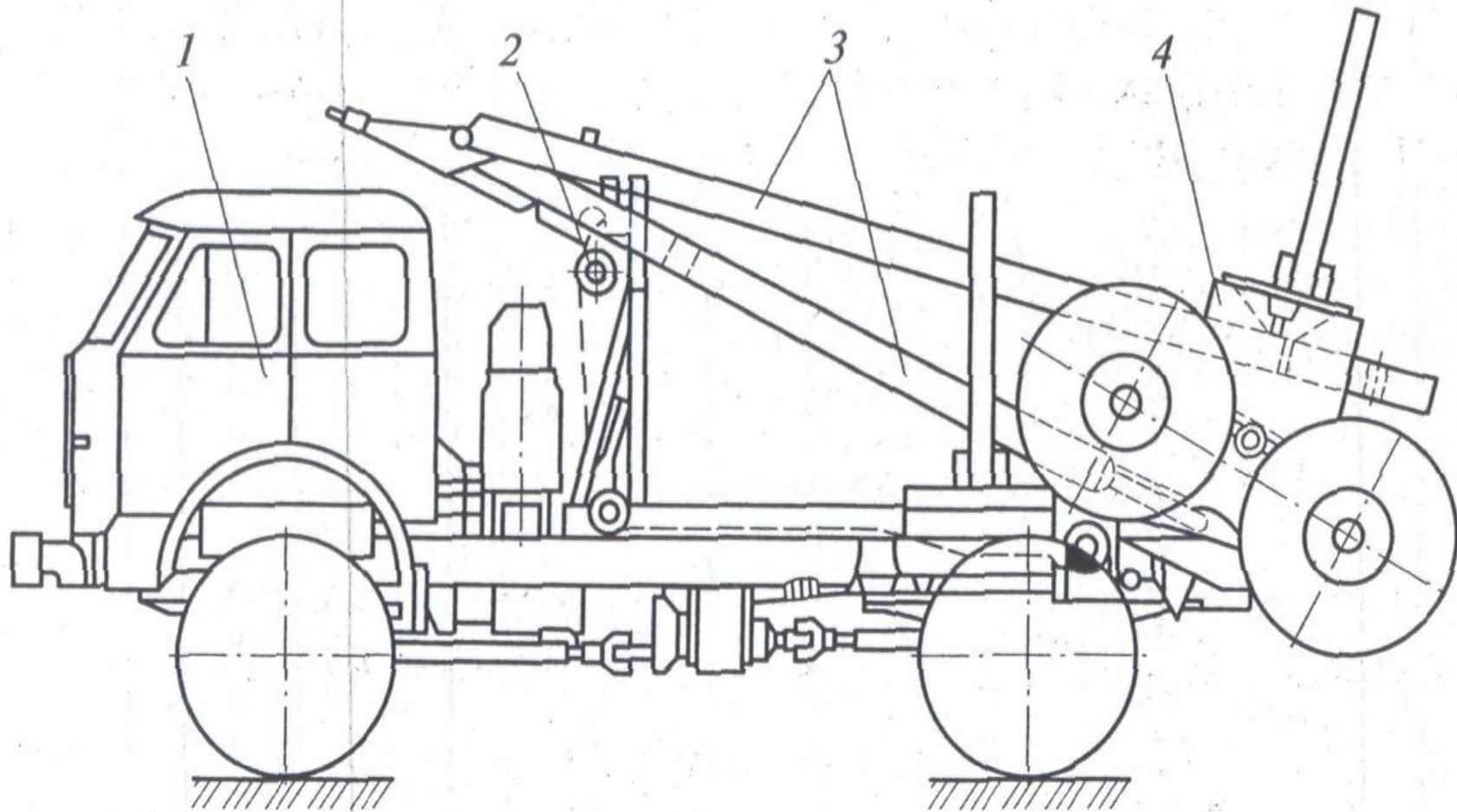
Рис. 4.2. Общий вид автомобиля со складывающимся дышлом:
