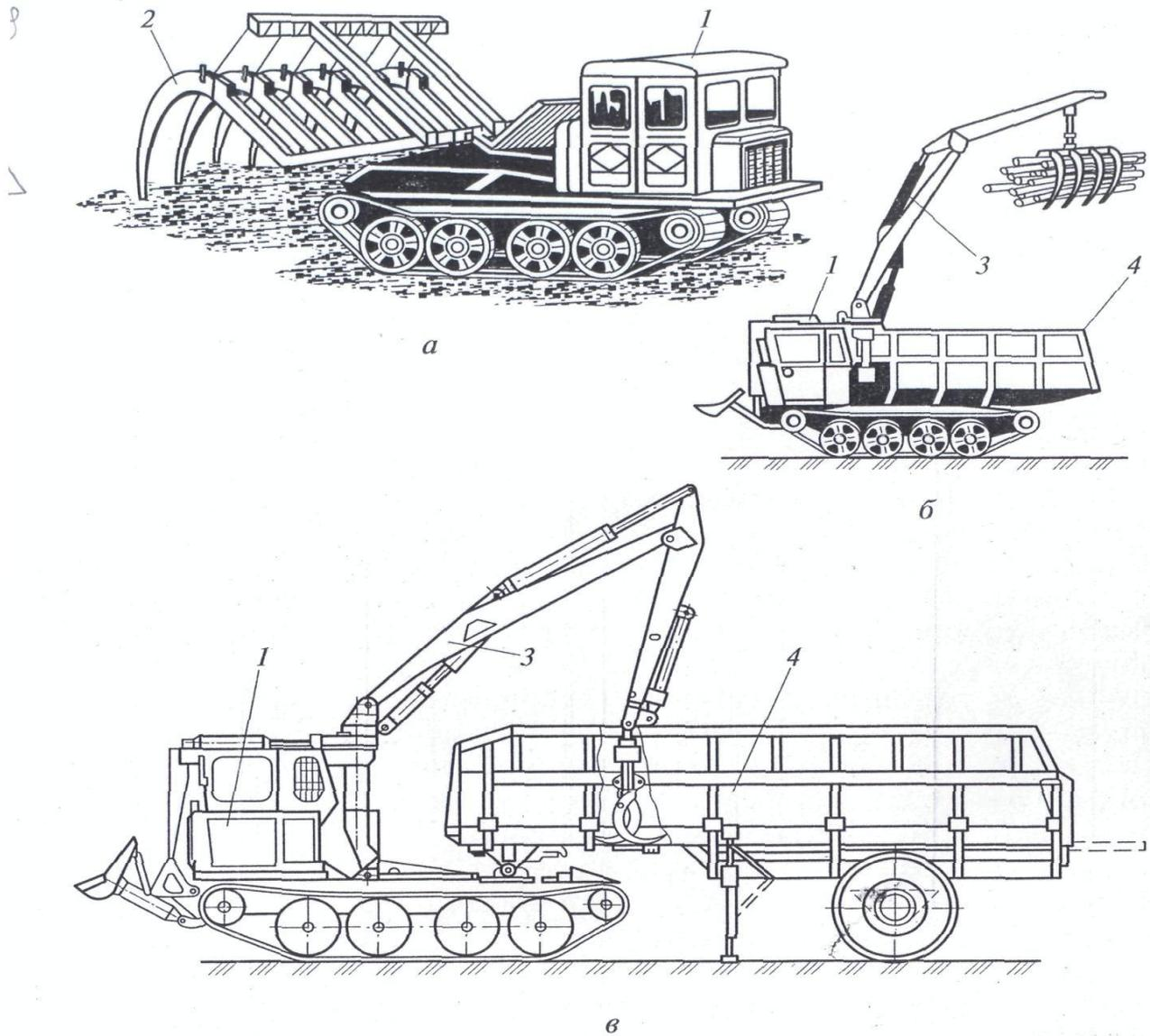
Рис. 1.14. Подборщики сучьев для очистки лесосек:
