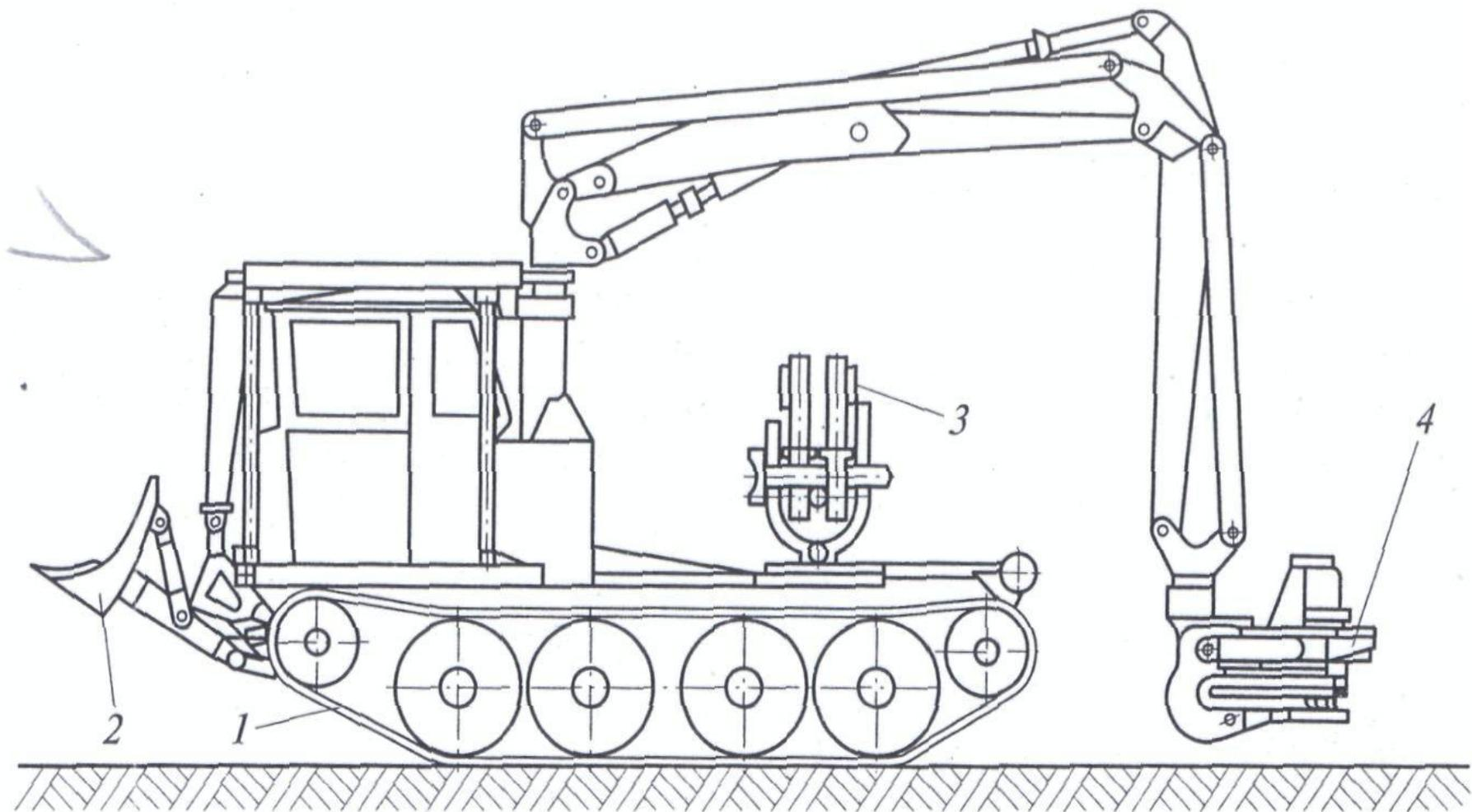
Рис. 1.7. Валочно-трелевочная машина ЛП-17:
