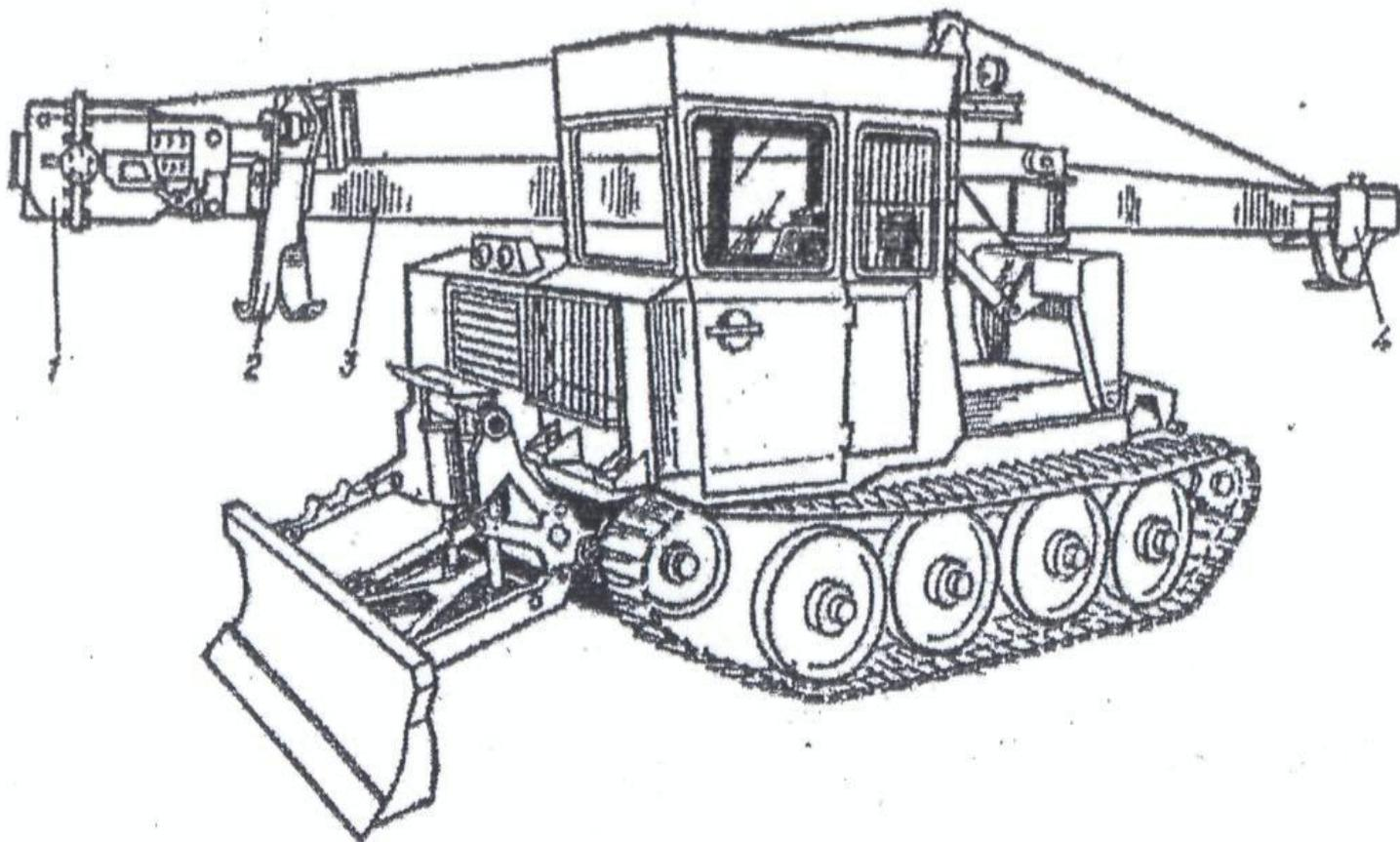
Рис. 2.15. Сучкорезная машина ЛП-30Г: 1 – гидрорубежка; 2 – приёмная головка; 3 – поворотная стрела; 4- сучкорезная головка
