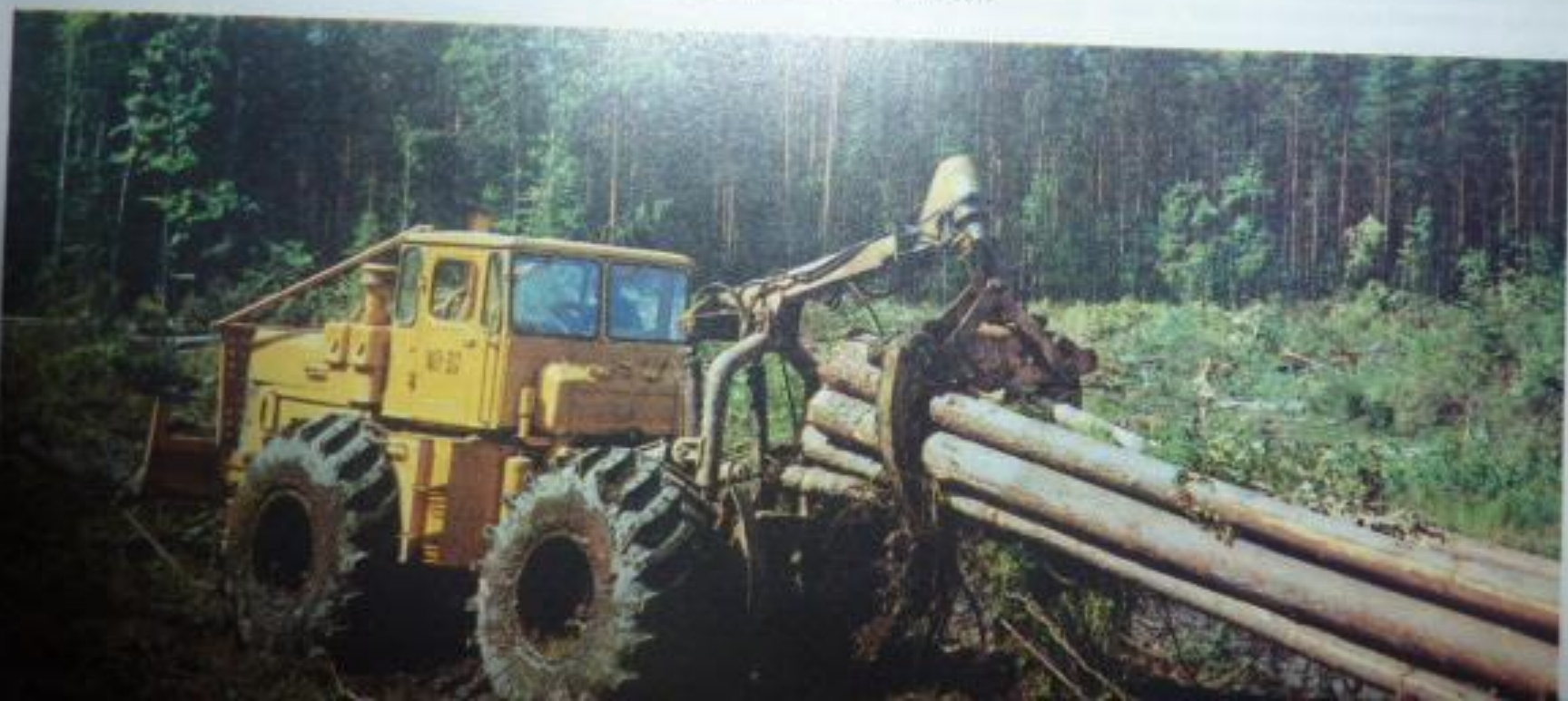
Трелёвочный трактор ЛТ-157.
